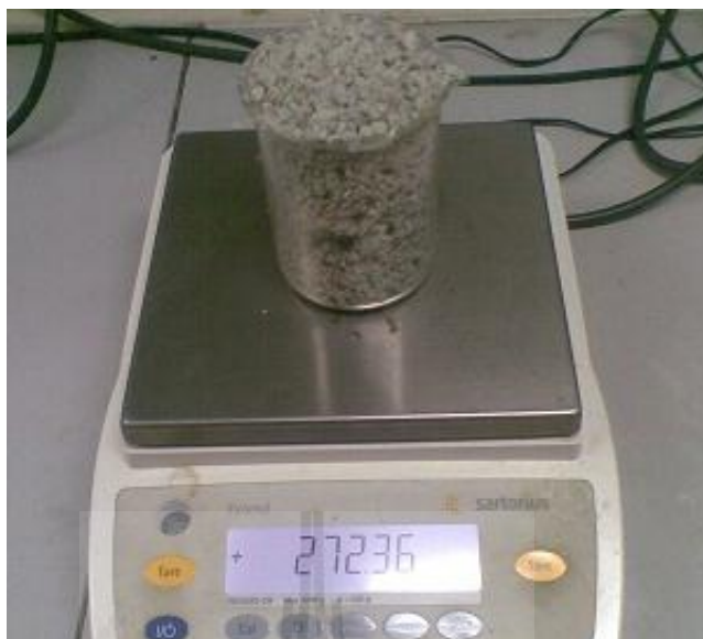
รูปที่ 3.10 การทดสอบหาความหนาแน่นปรากฏ
