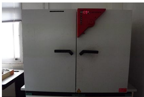
รูปที่ 3.4 ตู้อบแห้งแบบลมร้อน
