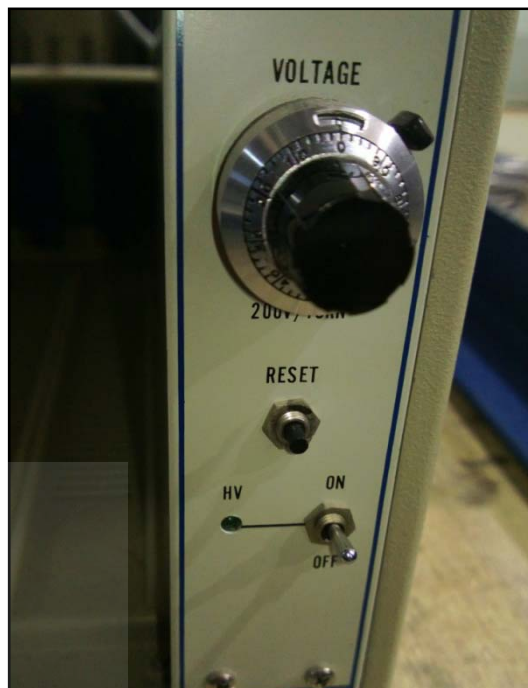
รูปที่ ข. 3.2 สวิตช์ ON/OFF และปุ่มหมุนปรับ ศักย์ไฟฟ้า
