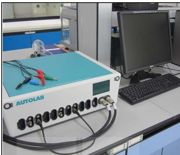
รูปที่ 3.13 เครื่องโพเทนชิโอสแตตสำหรับทดสอบการกัดกร่อน
