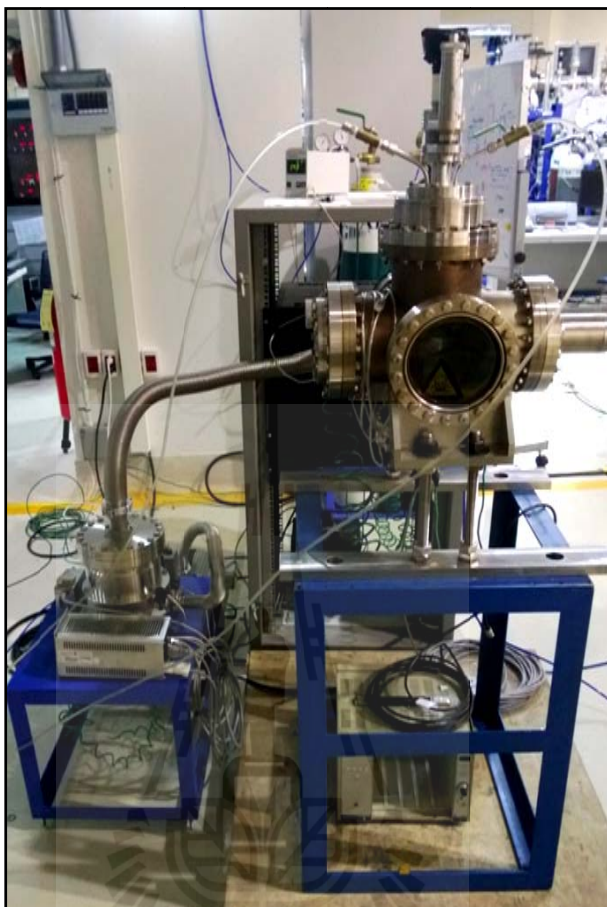
รูปที่ 3.12 เครื่องเคลือบ (ชั้นเคลือบ DLC) ฟิเตอร์ คาโรติกอาร์ทในระบบสุญญากาศ
