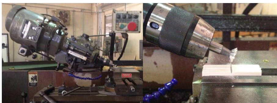
รูปที่ 3.11 การทำรอยบากชิ้นงานทดสอบแรงกระแทก
