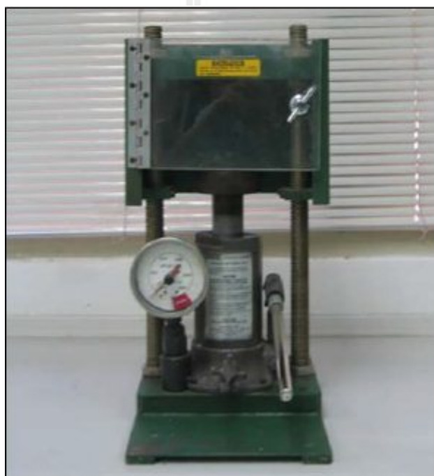
รูปที่ ก.6 เครื่องอัดไฮดรอลิก (hydraulic press)
