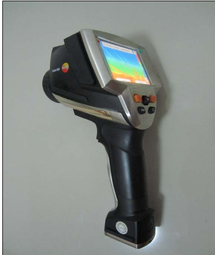
รูปที่ ก.1 กล้องถ่ายภาพความร้อน (Thermo imager) รุ่น TESCO 880
