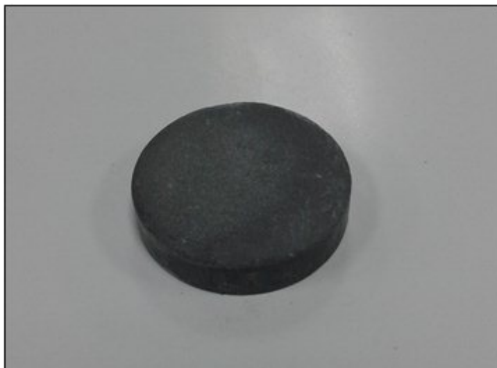
รูปที่ 7.10 ชิ้นงานตัวอย่างหลังการเผาผนึก
