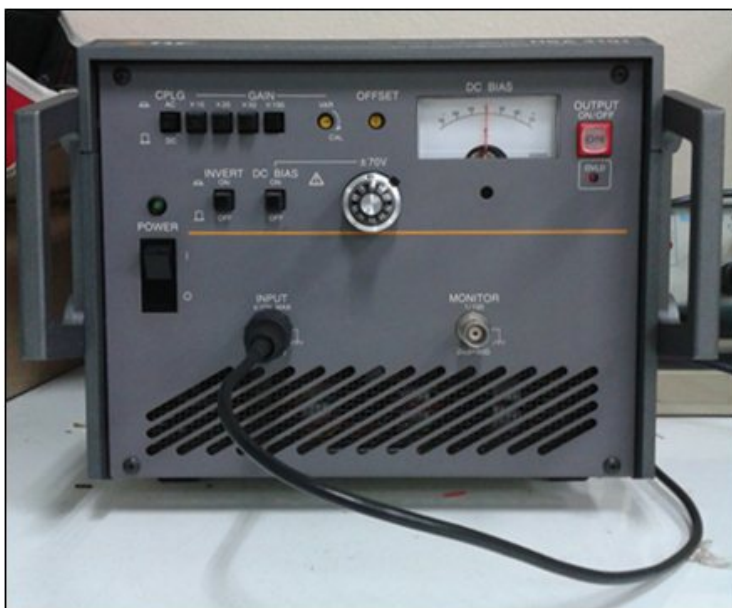
รูปที่ ก.4 เครื่อง power amplifier
