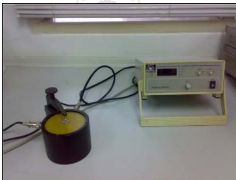
รูปที่ ก.10 เครื่องวัดค่า d33
