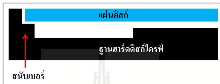
รูปที่ 3.10 ความสูงของสแน็บเบอร์ที่มีความสูง สูงกว่าความสูงของฐานฮาร์ดดิสก์ไครฟ์ที่บริเวณที่มีการจัดเก็บข้อมูล (แบบ ก.)
