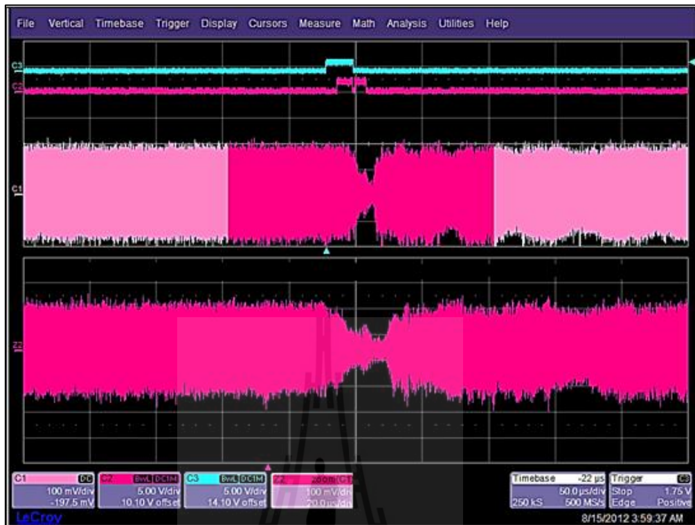
รูปที่ ก.4 แสดงความผิดปกติของการอ่านสัญญาณจากฮาร์ดดิสก์ไครฟ์แบบไม่มีสลับเบอร์
