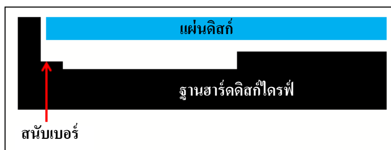
รูปที่ 3.11 ความสูงของสแน็บเบอร์ที่มีความสูง ต่ำกว่าความสูงของฐานฮาร์ดดิสก์ไครฟ์ที่บริเวณที่มีการจัดเก็บข้อมูล (แบบ ข.)
