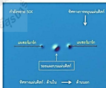
รูปที่ 8 บริเวณข้อมูลที่เกิดการสัมผัสกับฐานฮาร์ดดิสก์ไดรฟ์ภายใต้กล้องจุลทรรศน์ (กำลังขยาย 50x)
