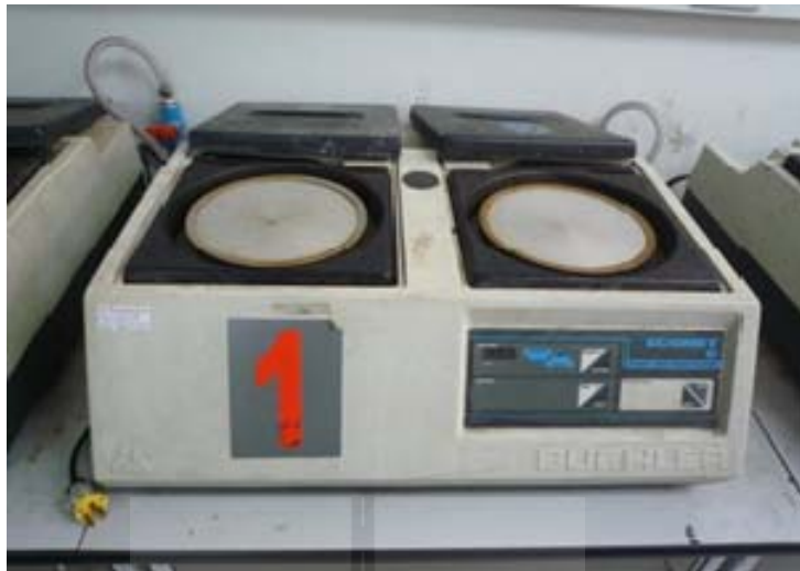
รูปที่ 3.2 เครื่องขัดผิวชิ้นงานแบบจานหมุนอีท้อ BUEHLER รุ่น ECOMET 6
