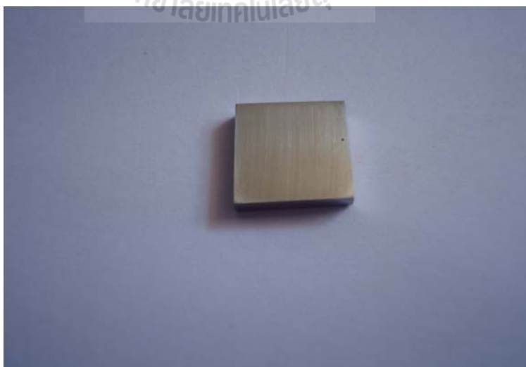
รูปที่ 3.11 อิเล็กโทรดตัวอย่าง (working electrode)
