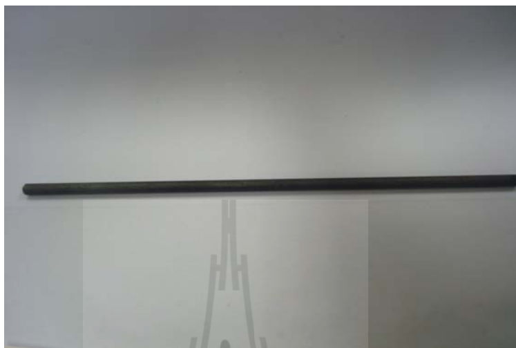
รูปที่ 3.10 อิเล็กโทรดวัดกระแส (counter electrode)
