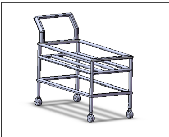
รูปที่ 4.5 รถเข็นงานฮาร์ดดิสก์ไครฟ์ขนาด 3.5 นิ้ว (บรรจุงานได้ 30 ชิ้น)
