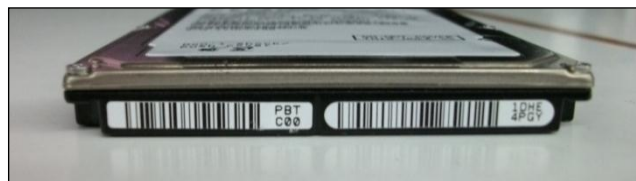
รูปที่ 1.2 แสดงตัวอย่างตำแหน่งการติด Barcode Label
