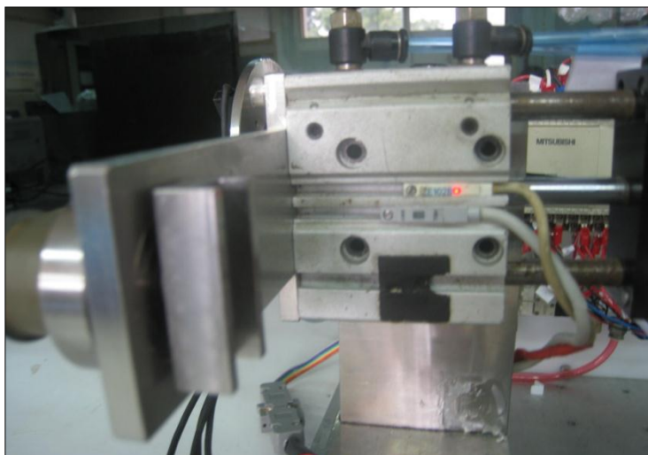
รูปที่ 3.10 แสดงตำแหน่งการติดตั้งรีดสวิทช์เพื่อการบอกตำแหน่งของ Gripper
