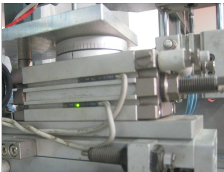
รูปที่ 3.11 แสดงตำแหน่งการติดตั้งรีดสวิทช์เพื่อควบคุมการหมุนชุดจับยึด
