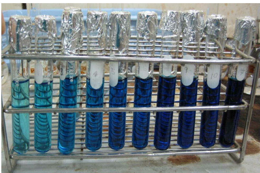
ภาพผนวกที่ 4 การทำปฏิกิริยาให้เกิดสีด้วยสารละลายไพรีดิน/ไพราโซโลนหลังบ่มที่อุณหภูมิห้องเป็นเวลา 40 นาที ก่อนนำไปวัดค่าการดูดกลืนคลื่นแสงที่ 620 nm
