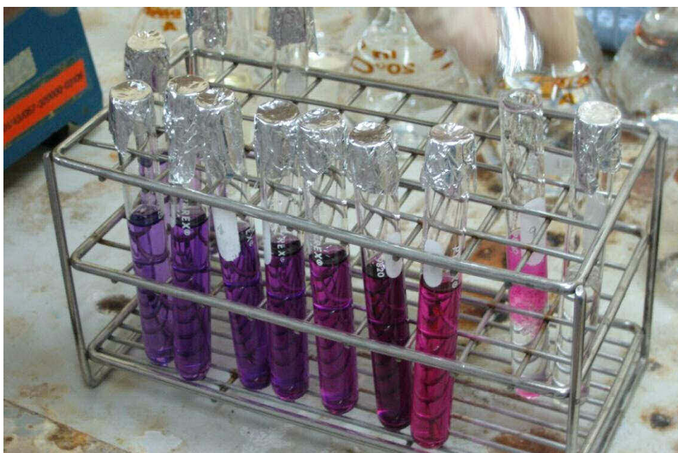
ภาพผนวกที่ 3 การทำปฏิกิริยาให้เกิดสีด้วยสารละลายไพรีดิน/ไพราโซโลนในการวิเคราะห์ปริมาณไซยาไนด์รวม
