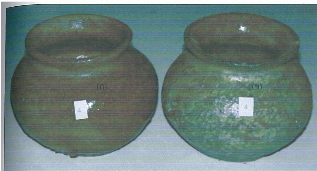
รูปที่ 117 เนื้อดินปั้นพิเศษ สูตรที่ 4 ของการทดลองที่ 9 ซึ่งเผาในเตาไม้ฟืนบริเวณ ไฟแรง
