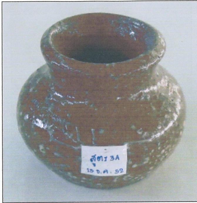
รูปที่ 140 เนื้อดินปั้นพิเศษสูตรที่ 3A ของการทดลองที่ 13 เผาในเตาไฟฟ้าที่ 1000 องศาเซลเซียส ยี่นไฟ 2 ชั่วโมง
