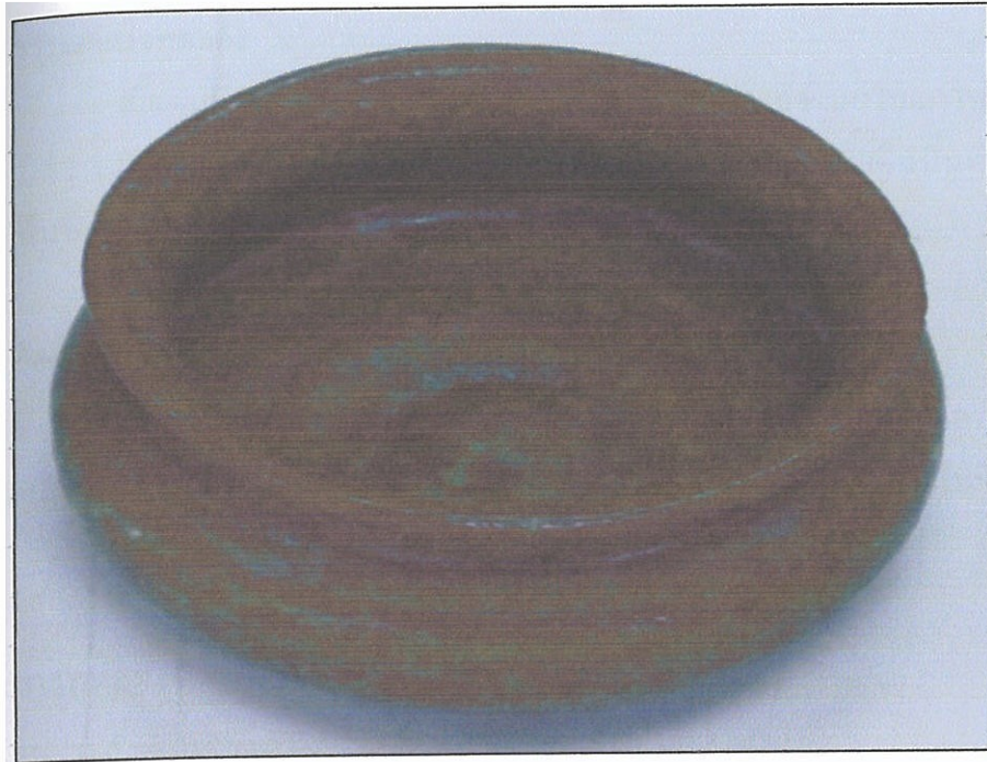
รูปที่ 98 เนื้อดินปั้นแบบพิเศษๆ ที่เผาในเตาไฟฟ้าที่อุณหภูมิ 1000 องศาเซลเซียส ขึ้นไฟ 2 ชั่วโมง
