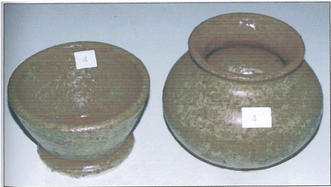
รูปที่ 113 เนื้อดินปั้นพิเศษ สูตรที่ 4 ของการทดลองที่ 9 ซึ่งผ่านการเผาในเตาไฟฟ้าที่ 1000 องศาเซลเซียส ยืนไฟ 2 ชั่วโมง
