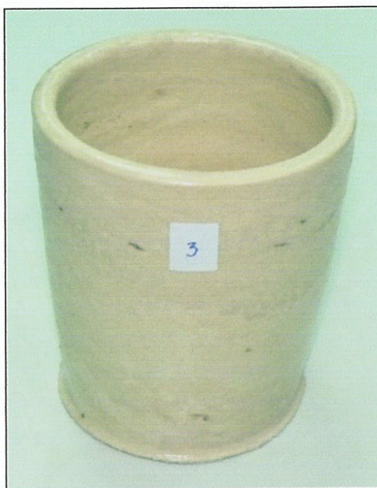
รูปที่ 127 เนื้อดินปั้นพิเศษสูตรที่ 3 ของการทดลองที่ 11 เเผาที่เตาไฟฟ้าที่ 1000 องศาเซลเซียส ยี่นไฟ 2 ชั่วโมง
