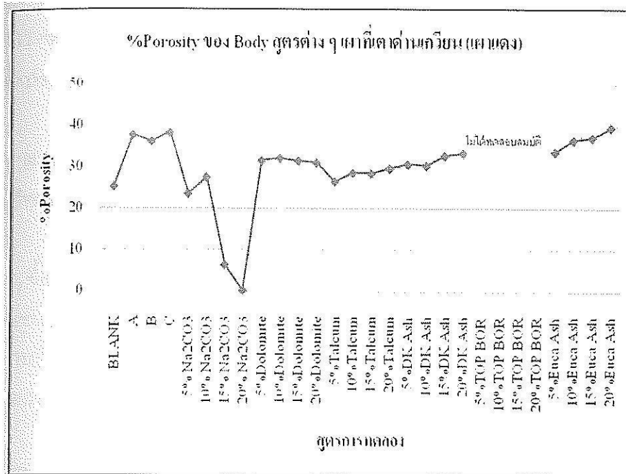
รูปที่ 35 เปอร์เซ็นต์ความพรุนตัว (% Porosity) ของส่วนผสมสูตรต่าง ๆ เฝ้าที่เตาด่านเกวียน
