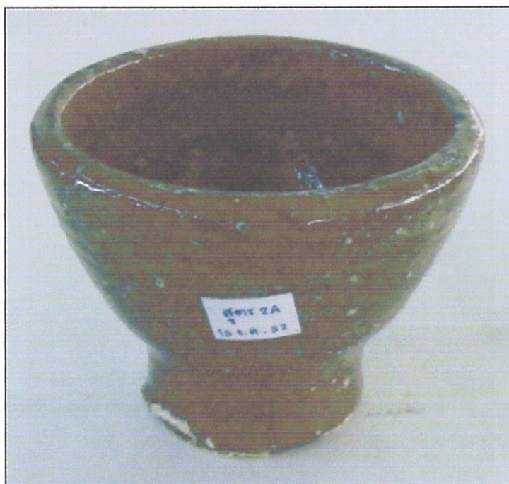
รูปที่ 139 เนื้อดินปั้นพิเศษสูตรที่ 2A ของการทดลองที่ 13 เผาในเตาไฟฟ้าที่ 1000 องศาเซลเซียส เย็นไฟ 2 ชั่วโมง
