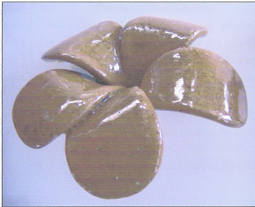
รูปที่ 85 ชิ้นงานที่ทำจากเนื้อดินปั้นด้านเหนียว 70% + โซดาแอช 10% + ทัลคัม 10% และ ฟริต B 10% เผาที่อุณหภูมิ 1000 องศาเซลเซียส ยืนไฟ 2 ชั่วโมง เผาในเตาไฟฟ้า ที่อุณหภูมิ 1000 องศาเซลเซียส
