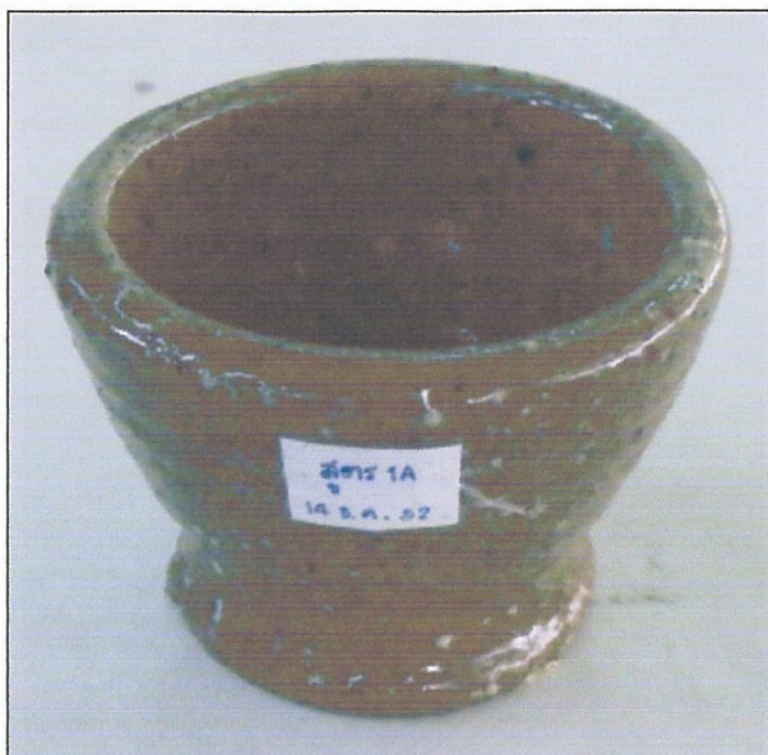
รูปที่ 138 เนื้อดินปั้นพิเศษสูตรที่ 1A ของการทดลองที่ 13 เผาในเตาไฟฟ้าที่ 1000 องศาเซลเซียส เย็นไฟ 2 ชั่วโมง
