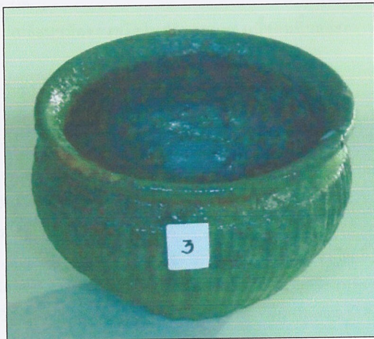
รูปที่ 116 เนื้อดินปั้นพิเศษ สูตรที่ 3 ของการทดลองที่ 9 ซึ่งเผาในเตาไม้พื้นบริเวณไฟกลาง
