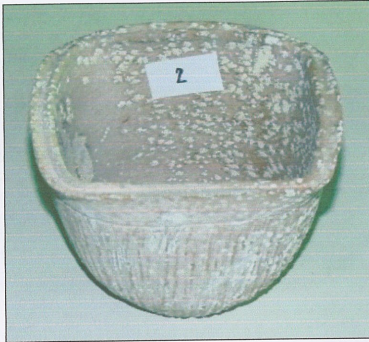
รูปที่ 115 เนื้อดินปั้นพิเศษ สูตรที่ 2 ของการทดลองที่ 9 ซึ่งเผาในเตาไม้พื้นบริเวณไฟอ่อน
