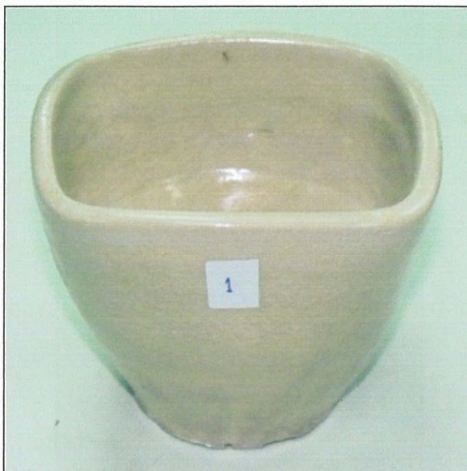
รูปที่ 125 เนื้อดินปั้นพิเศษสูตรที่ 1 ของการทดลองที่ 11 เผาที่เตาไฟฟ้าที่ 1000 องศาเซลเซียส ยี่นไฟ 2 ชั่วโมง
