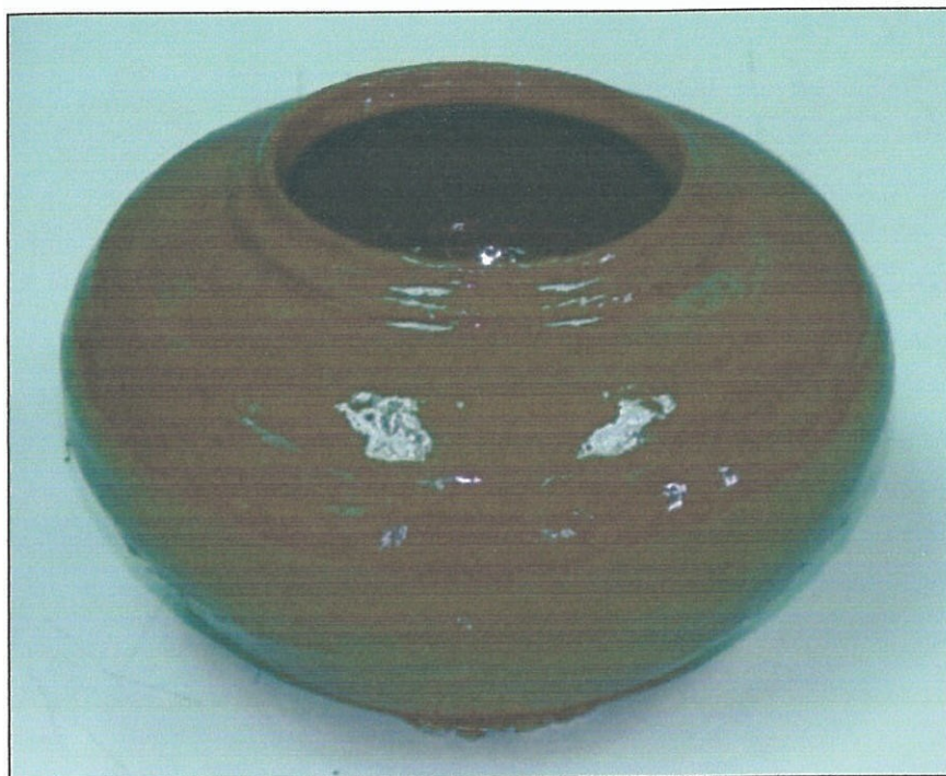
รูปที่ 118 เนื้อดินปั้นพิเศษสูตรที่ 1 ของการทดลองที่ 10 ที่ใช้ฟริต B หรือ ฟริต CG466 เผาในเตาไฟฟ้าที่ 1000 องศาเซลเซียส ยืนไฟ 2 ชั่วโมง
