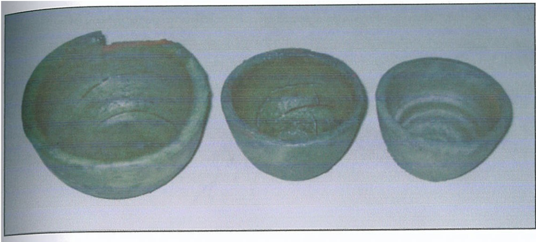
รูปที่ 107 เนื้อดินปั้นที่เตรียมด้วยวิธีที่ 1 ที่เผาในเตาฟืนของ โรงงานคุณสม เป้ากระโทก
