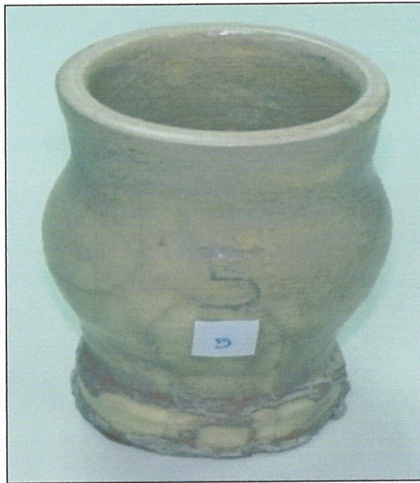
รูปที่ 129 เนื้อดินปั้นพิเศษสูตรที่ 5 ของการทดลองที่ 11 เเผาที่เตาไฟฟ้าที่ 1000 องศาเซลเซียส ยีนไฟ 2 ชั่วโมง
