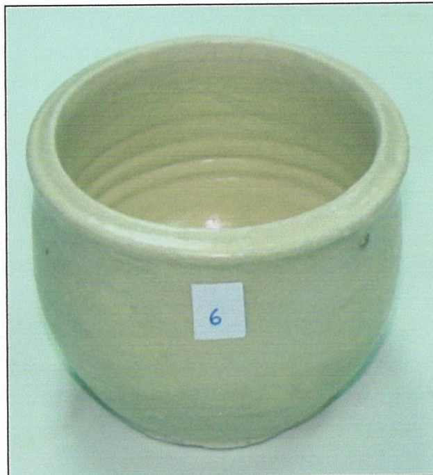
รูปที่ 130 เนื้อดินปั้นพิเศษสูตรที่ 6 ของการทดลองที่ 11 เเผาที่เตาไฟฟ้าที่ 1000 องศาเซลเซียส ยีนไฟ 2 ชั่วโมง
