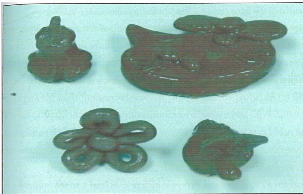
รูปที่ 120 เนื้อดินปั้นพิเศษสูตรที่ 3 ของการทดลองที่ 10 ซึ่งเผาในเตาไฟฟ้าที่ 1000 องศาเซลเซียส ยี่นไฟ 2 ชั่วโมง
