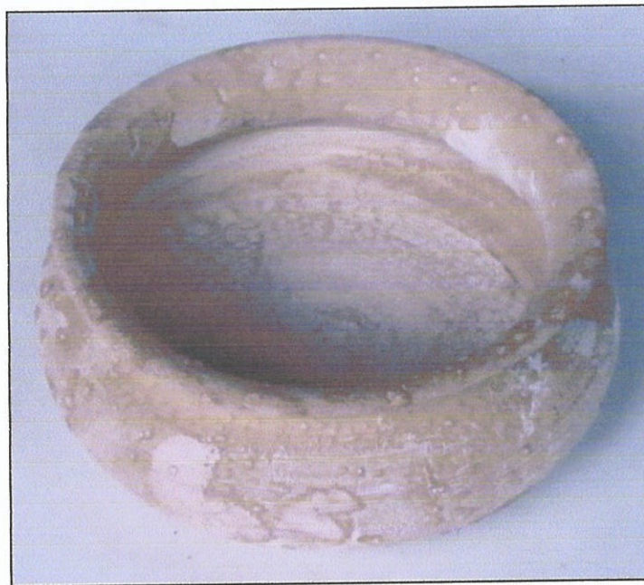
รูปที่ 96 เนื้อดินปั้นพิเศษๆ ที่ผ่านการขึ้นรูปและอบแล้วแต่ยังไม่เผา
