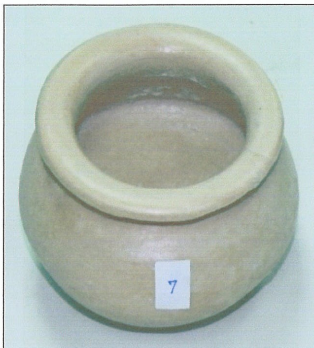
รูปที่ 131 เนื้อดินปั้นพิเศษสูตรที่ 7 ของการทดลองที่ 11 เเผาที่เตาไฟฟ้าที่ 1000 องศาเซลเซียส ยีนไฟ 2 ชั่วโมง
