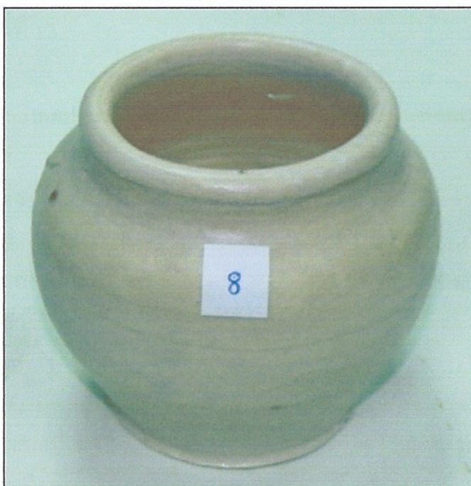
รูปที่ 132 เนื้อดินปั้นพิเศษสูตรที่ 8 ของการทดลองที่ 11 เเผาที่เตาไฟฟ้าที่ 1000 องศาเซลเซียส ยีนไฟ 2 ชั่วโมง
