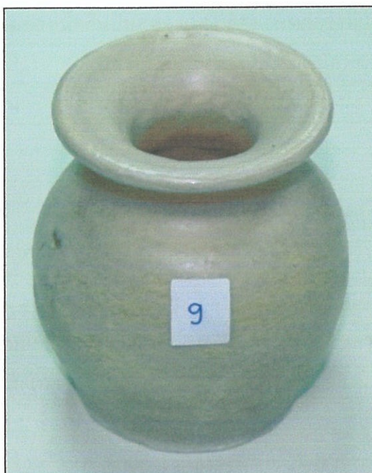
รูปที่ 133 เนื้อดินปั้นพิเศษสูตรที่ 9 ของการทดลองที่ 11 เผาที่เตาไฟฟ้าที่ 1000 องศาเซลเซียส เย็นไฟ 2 ชั่วโมง
