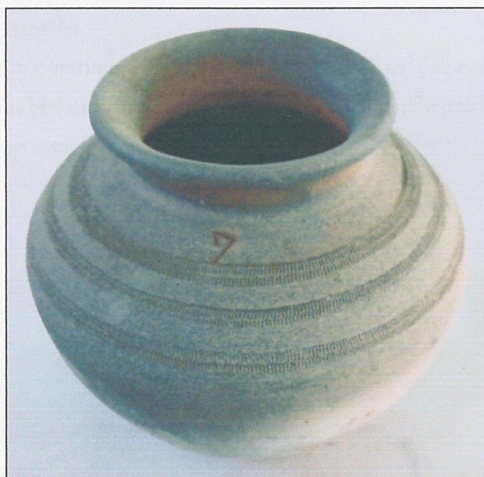
รูปที่ 147 เนื้อดินปั้นพิเศษสูตรที่ 7A ของการทดลองที่ 13 เสาในเตาไม้ฟืนที่ด่านเกวียน
