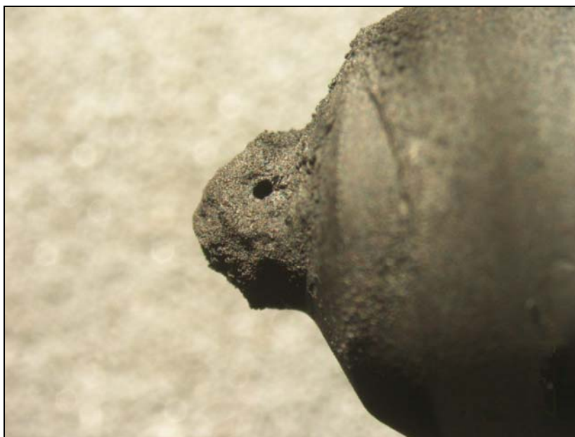
รูปที่ 4.16 หัวฉีดเครื่องยนต์ Cummins ที่มีเขม่าเมื่อใช้น้ำมัน B20 ที่ 1,800 รอบต่อนาที
