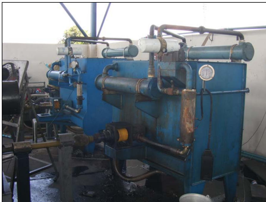
รูปที่ 3.5 เครื่อง SUT – Dynamometer Model SUT-HYDURA-180
