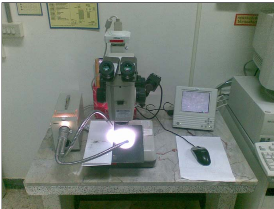
รูปที่ 3.10 กล้อง Nikon 40x Model MSZ-U ต่อเชื่อมกับเครื่อง Nikon Digital Sight DS-11
