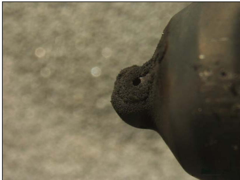
รูปที่ 4.15 หัวฉีดเครื่องยนต์ Cummins ที่มีเขม่าจับเมื่อใช้น้ำมันดีเซลที่ 1,800 รอบต่อนาที
