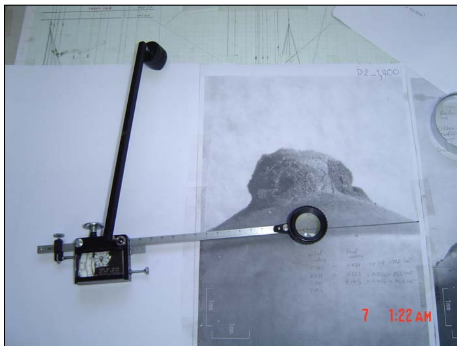
รูปที่ 3.11 เครื่องมือหาพื้นที่เขม่าที่จับที่หัวฉีด (Plane meter)
