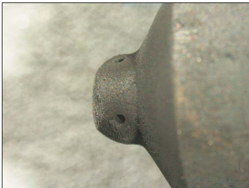
รูปที่ 4.10 หัวฉีดเครื่องยนต์ Hino ที่มีเขม่าจับอันเมื่อใช้น้ำมันดีเซลที่ 1,800 รอบต่อนาที
