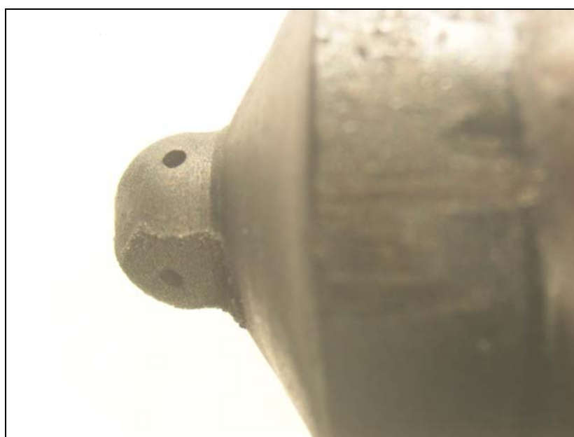
รูปที่ 4.21 หัวฉีดเครื่องยนต์ Komatsu ที่มีเขม่าจับเมื่อใช้น้ำมัน B20 ที่ 1,800 รอบต่อนาที
