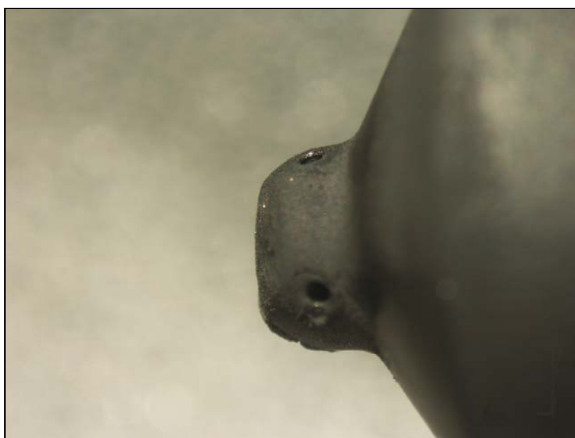
รูปที่ 4.13 หัวฉีดเครื่องยนต์ Hino ที่มีเขม่าจับเมื่อใช้น้ำมัน B100 ที่ 1,800 รอบต่อนาที
