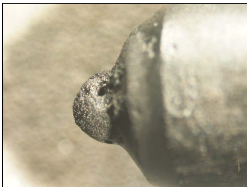
รูปที่ 4.18 หัวฉีดเครื่องยนต์ Cummins ที่มีเขม่าจับเมื่อใช้น้ำมัน B100 ที่ 1,800 รอบต่อนาที
