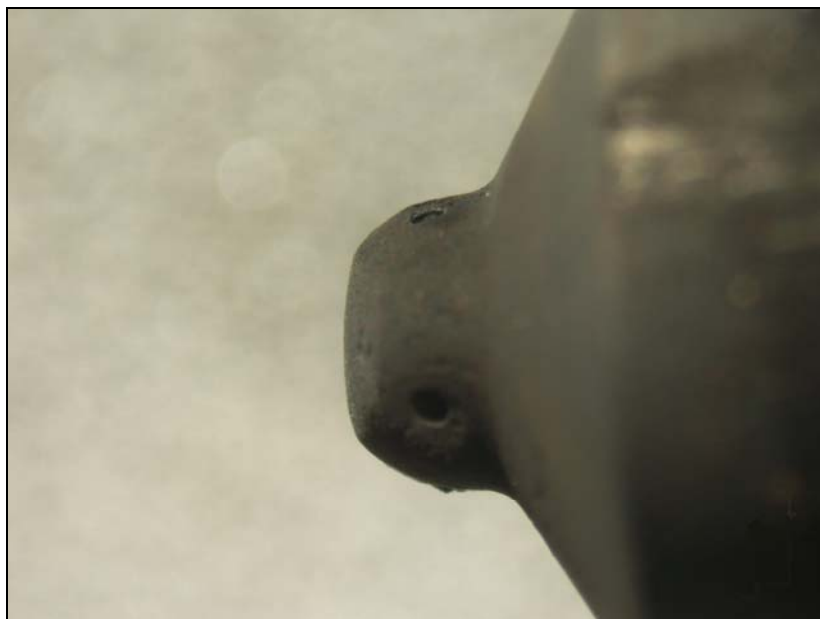
รูปที่ 4.12 หัวฉีดเครื่องยนต์ Hino ที่มีเขม่าจับเมื่อใช้น้ำมัน B50 ที่ 1,800 รอบต่อนาที
