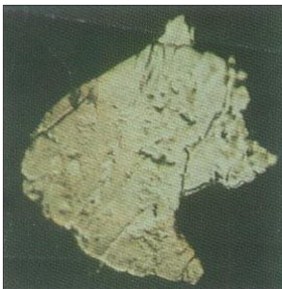
รูปที่ 2.15 แสดงอนุภาคการสึกหรอที่เกิดจากการล้าบนเฟือง
