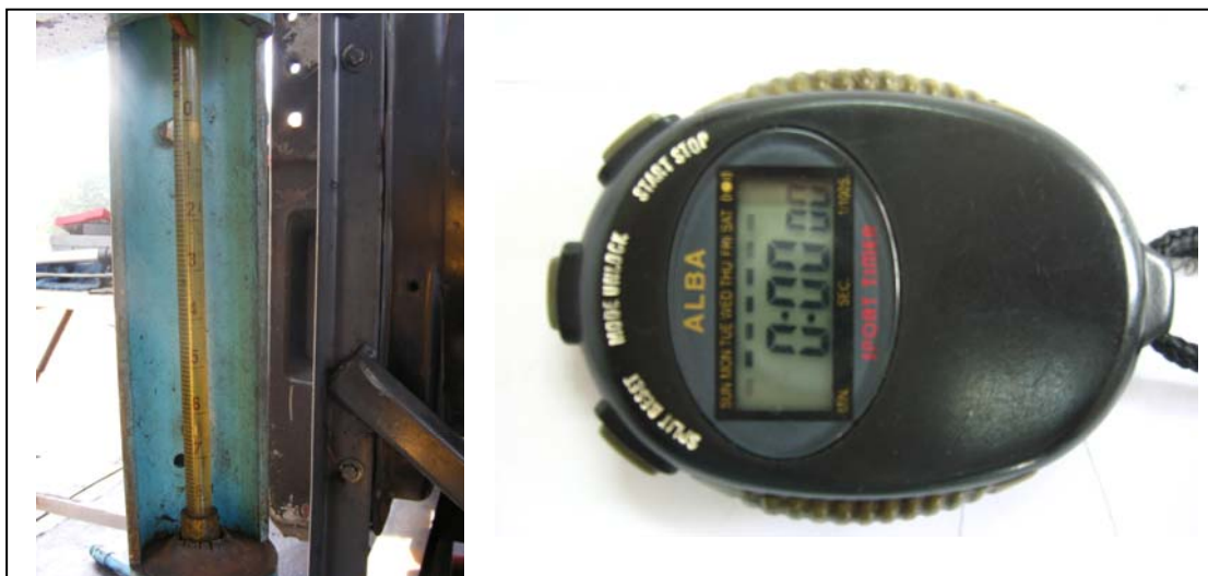
รูปที่ 3.7 เครื่องวัดอัตราการสิ้นเปลืองน้ำมันเชื้อเพลิงแบบหลอดแก้วพร้อมนาฬิกาจับเวลา
