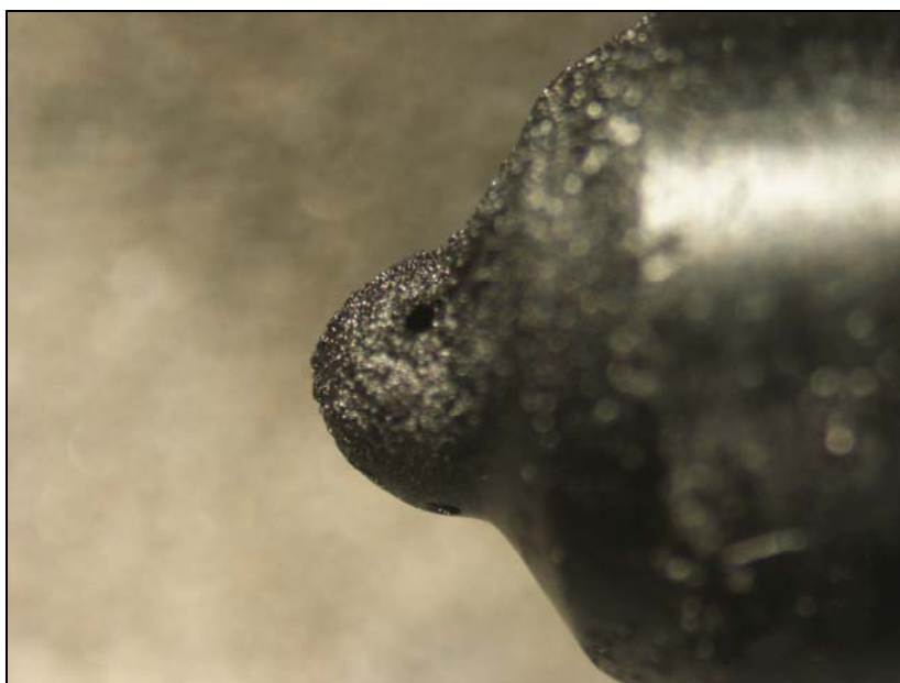
รูปที่ 4.17 หัวฉีดเครื่องยนต์ Cummins ที่มีเขม่าจับเมื่อใช้น้ำมัน B50 ที่ 1,800 รอบต่อนาที
