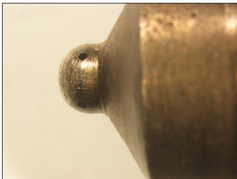
รูปที่ 4.19 หัวฉีดเครื่องยนต์ Komatsu ที่ล้างสะอาด
