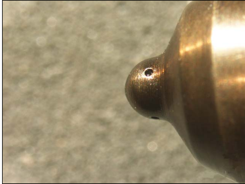
รูปที่ 4.14 หัวฉีดเครื่องยนต์ Cummins ที่ล้างสะอาด
