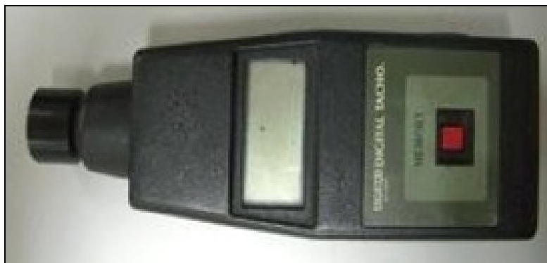
รูปที่ 3.8 เครื่องวัดความเร็วรอบเครื่องยนต์ (tachometer)
