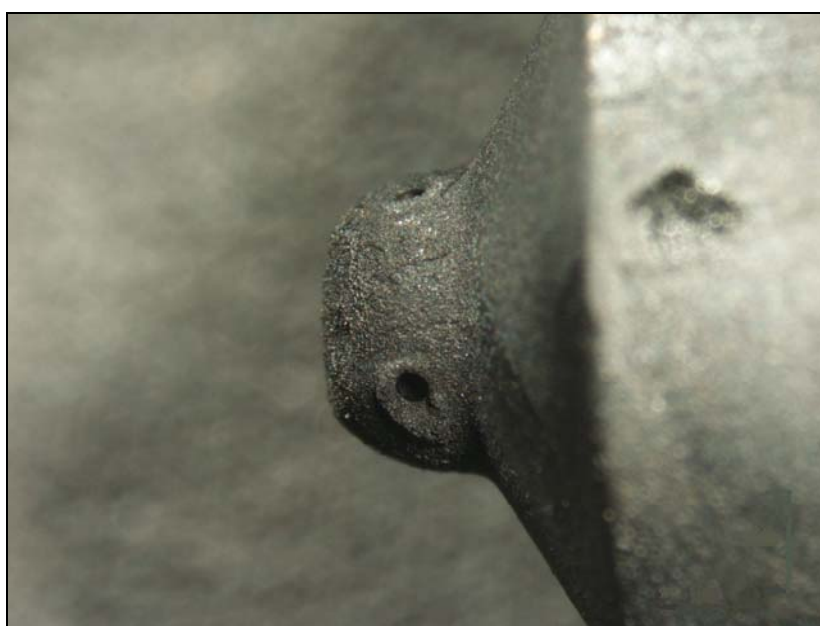
รูปที่ 4.11 หัวฉีดเครื่องยนต์ Hino ที่มีเขม่าจับอันเมื่อใช้น้ำมัน B20 ที่ 1,800 รอบต่อนาที
