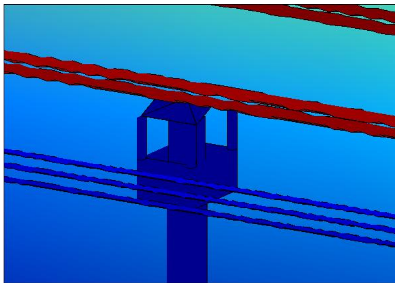
รูปที่ 7.47 กระจายสนามไฟฟ้า (kV/m) แบบ 3 มิติบริเวณกระเช้าเมื่อบุคลากรขึ้นไปปฏิบัติงานด้วยกระเช้ารถยกที่ติดตั้งหลังคาโค้งทำมุม 40^\circ
