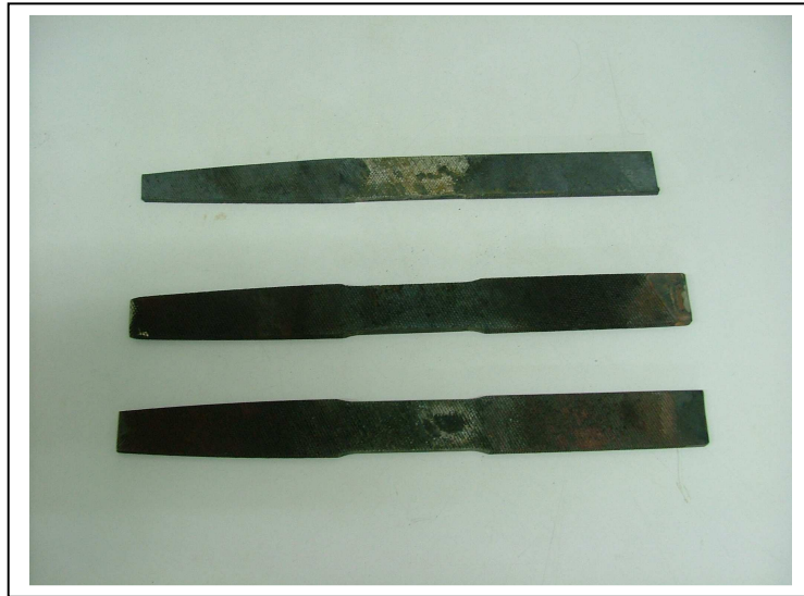
รูปที่ 6.4 การเตรียมเหล็กเชื่อมสภาพสำหรับเข้าเครื่องทดสอบความยืดตัว
