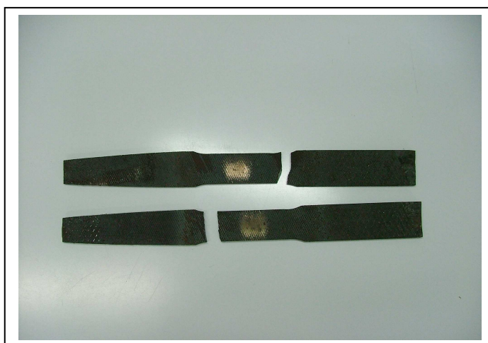
รูปที่ 6.6 (ข) เหล็กเสื่อมสภาพผ่านการอบชุบที่ถูกดึงจนขาดออกจากกัน โดยเครื่องทดสอบการยึดตัวของวัสดุ เนื้อเหล็กจะไม่แตกแต่จะแยกเป็นแนว
