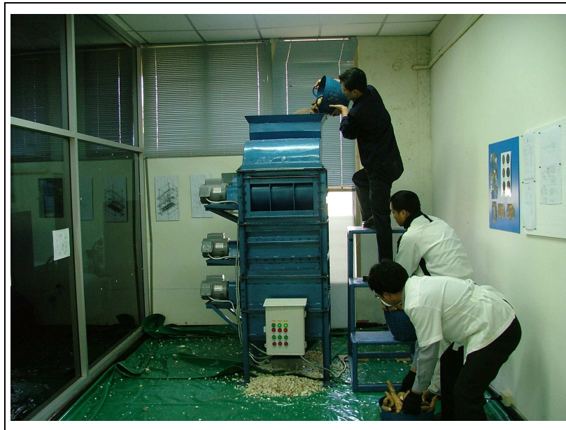
รูปที่ 7.8 การเทวัสดุทดสอบเข้าไปปรับจนสภาวะการทำงานของระบบควบคุม
