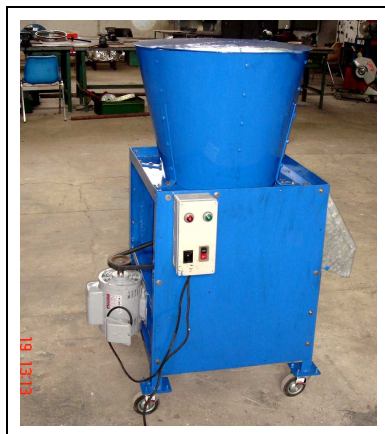
รูปที่ 2.2 เครื่องย่อยขนาดหัวมันสำปะหลังเพื่อผลิตอาหารสัตว์ (เกษมสันต์ แสงเงิน และคณะ, 2549)
