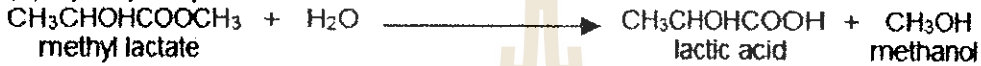
รูปภาพ 2 แผนผังการผลิตกรดแล็กติกโดยวิธีทางเคมี (Narayanan et al. , 2004b)
