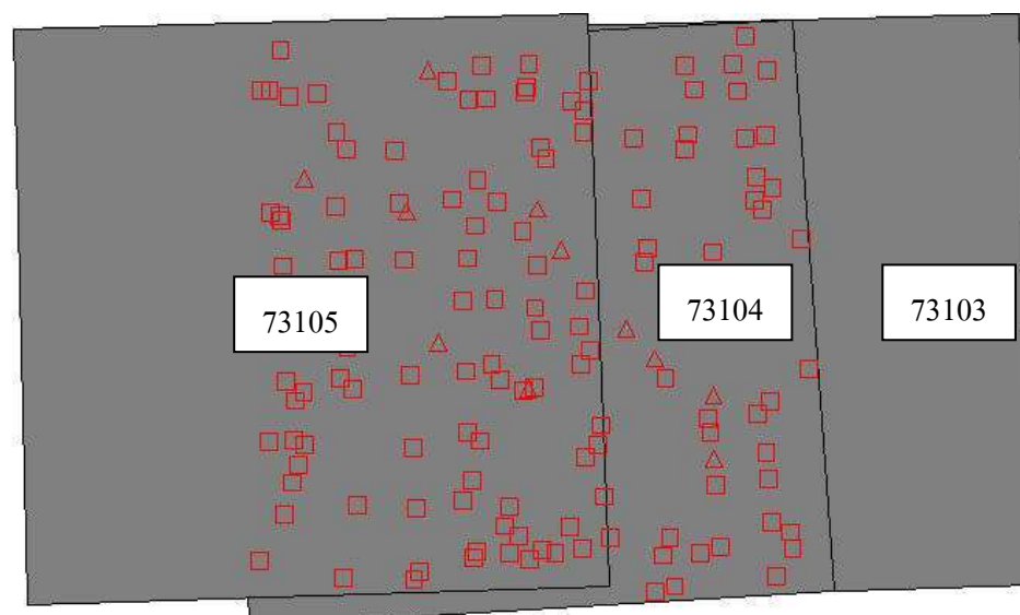
ภาพที่ 4.7 แสดงจุดโยงหรือ Tie Point (□) จำนวน 134 จุด ที่ขยายออกไปจากจุดควบคุมหลัก (Δ)
