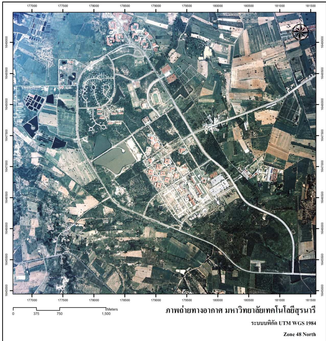
ภาพที่ 4.24 แสดงภาพถ่ายทางอากาศที่ตัดแก้ด้วยสมการ โพลีโนเมียล
