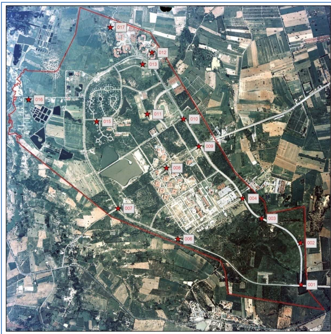
ภาพที่ 4.4 ภาพแสดงการกระจายตัวของจุดควบคุมภาพถ่ายที่เลือกไว้สำหรับการรังวัดด้วย DGPS
