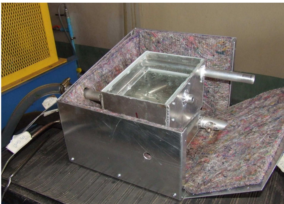
รูปที่ 4.18 โครงสร้างภายนอกและภายในของเครื่องกลั่นเอทานอลต้นแบบ
