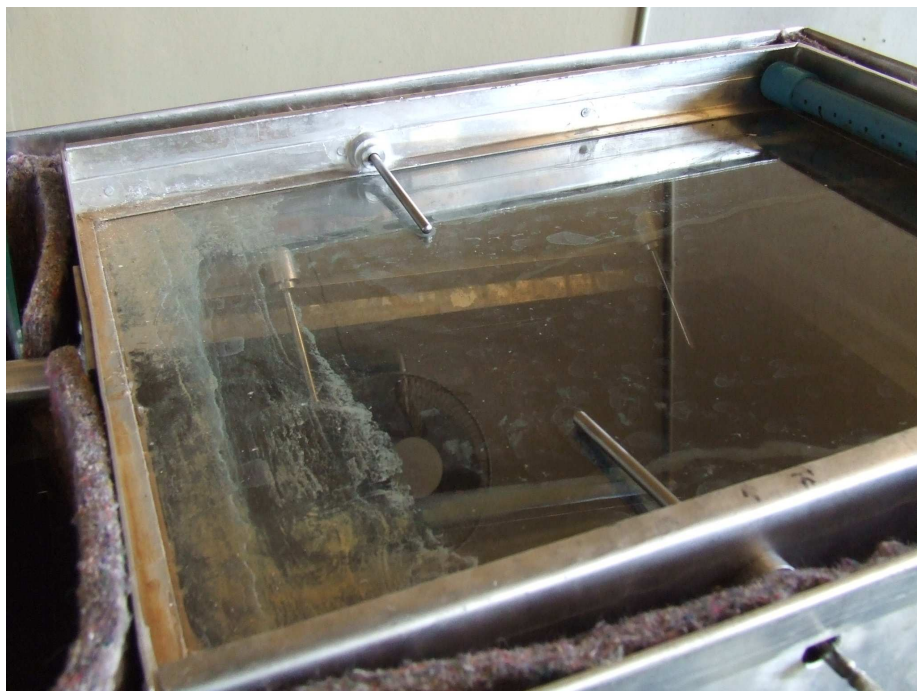
รูปที่ 4.4 ตำแหน่งติดตั้งจุดวัดอุณหภูมิ
