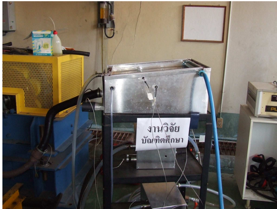
รูปที่ 4.1 เครื่องมือทดสอบหาค่า Mass Transfer Conductance
