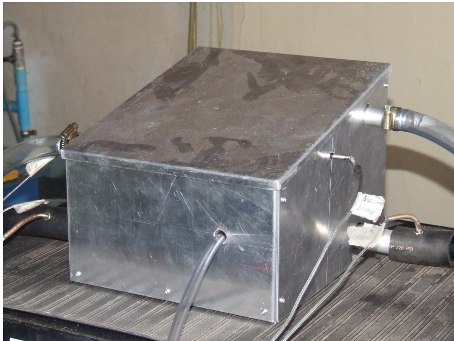
รูปที่ 4.15 เครื่องกลั่นเอทานอลต้นแบบ
