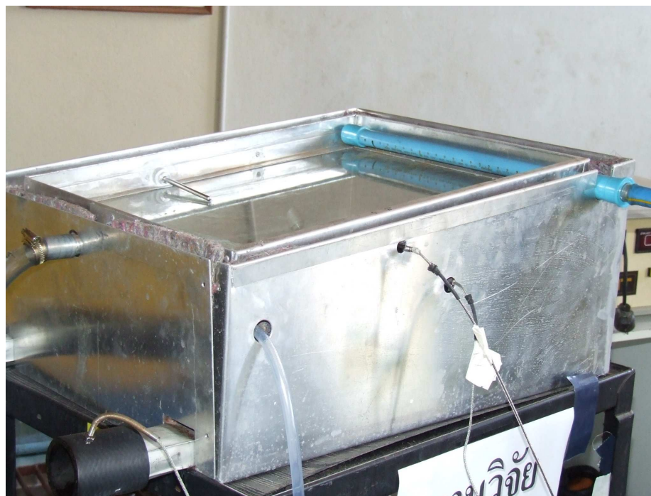
รูปที่ 4.2 ผิวควบคุมแน่นและระบบหล่อเย็น
