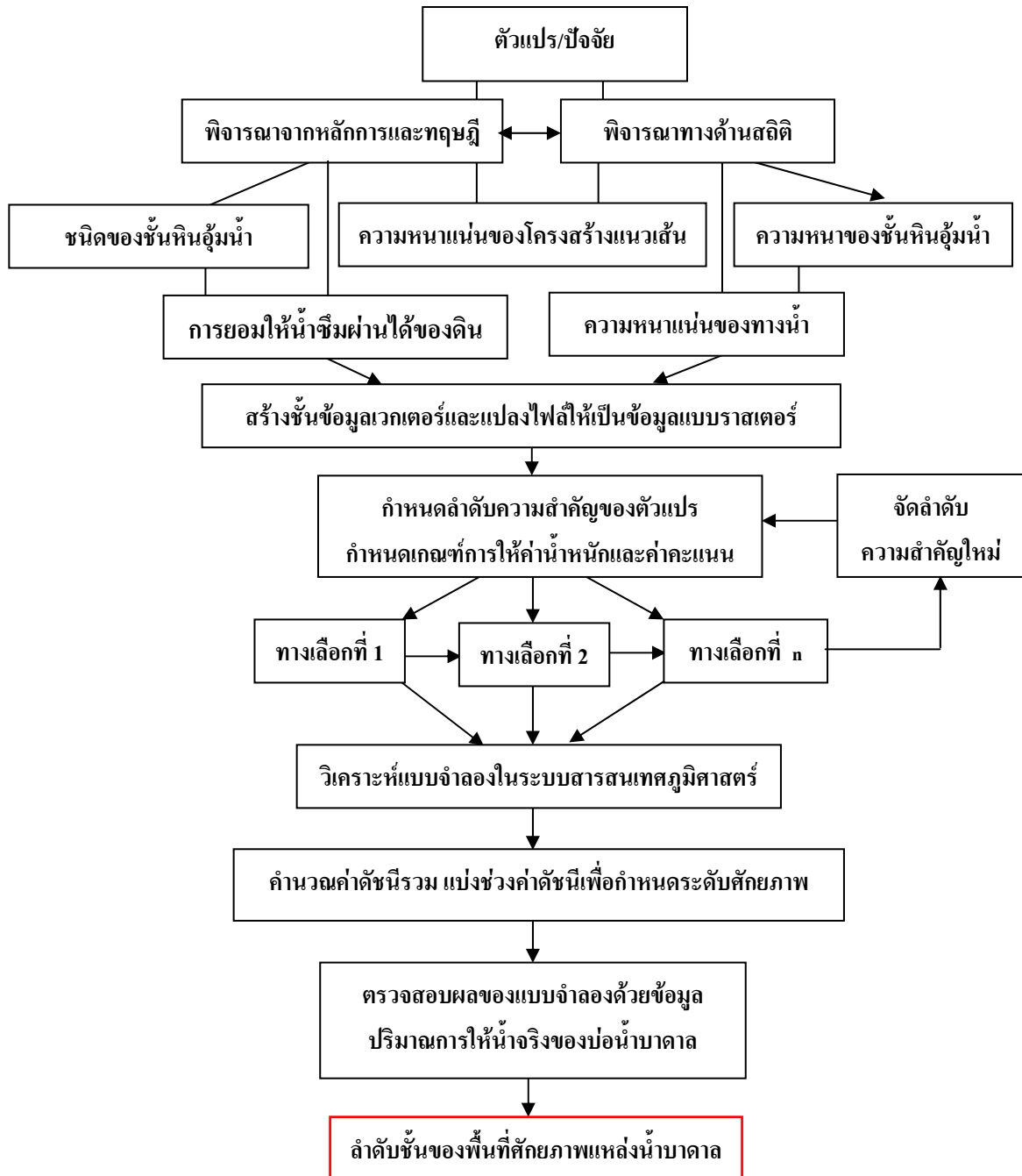
ภาพที่ 3.3 แสดงวิธีการศึกษาแบบจำลองดัชนีชี้วัดเชิงพื้นที่
