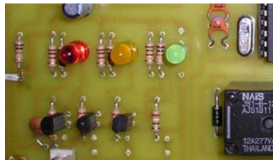
รูป 3.4 แสดงส่วนของ LED แทนการทำงานของ Sensor ทั้ง 3 ระดับ
