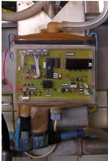
รูป 4.13 แสดงเครื่องชั่งน้ำนมและเครื่องควบคุมของระบบเดิมซึ่งมีความเสียหายและใช้การไม่ได้ในบางส่วน
