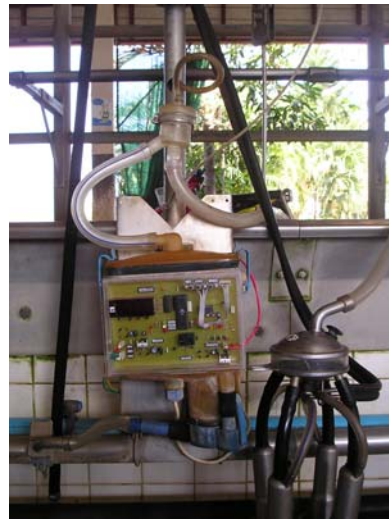
รูป 4.13 แสดงเครื่องชั่งน้ำนมและเครื่องควบคุมของระบบเดิมซึ่งมีความเสียหายและใช้การไม่ได้ในบางส่วน
