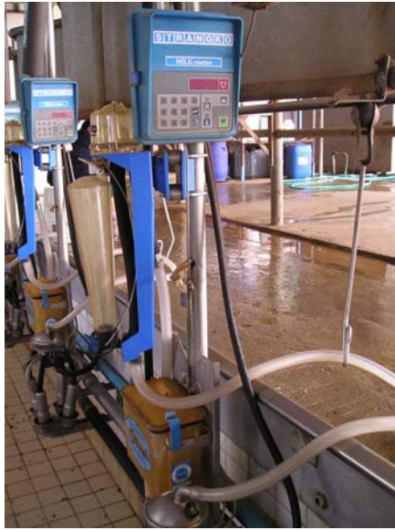
รูป 4.13 แสดงเครื่องชั่งน้ำนมและเครื่องควบคุมของระบบเดิมซึ่งมีความเสียหายและใช้การไม่ได้ในบางส่วน
