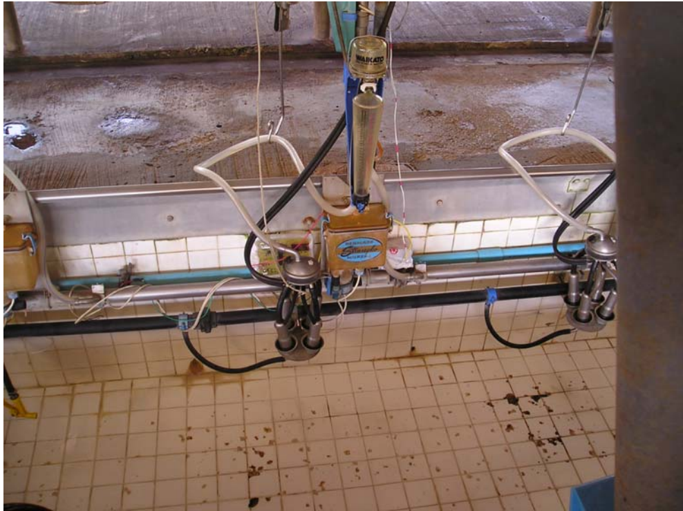
รูป 4.14 ง) แสดงเครื่องควบคุมการชั่งน้ำนมที่สร้างขึ้น โดยทำการติดตั้งกับเครื่องชั่งน้ำนมของระบบเดิมเพื่อทดสอบความสามารถในการทำงานร่วมกัน
