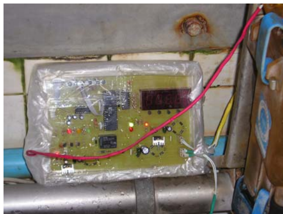
รูป 4.14 ค) แสดงเครื่องควบคุมการชั่งน้ำนมที่เราสร้างขึ้นโดยทำการติดตั้งกับเครื่องชั่งน้ำนมของระบบเดิมเพื่อทดสอบความสามารถในการทำงานร่วมกัน
