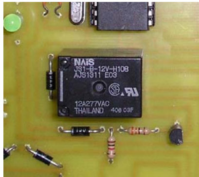
รูป 3.7 แสดงส่วนของHard Ware ของ รีเลย์ และวาล์วที่จะควบคุมในระบบเดิม
