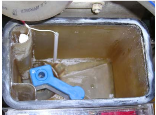
รูป 4.14 ข) แสดงเครื่องควบคุมการชั่งน้ำนมที่เราสร้างขึ้นโดยทำการติดตั้งกับเครื่องชั่งน้ำนมของระบบเดิมเพื่อทดสอบความสามารถในการทำงานร่วมกัน
