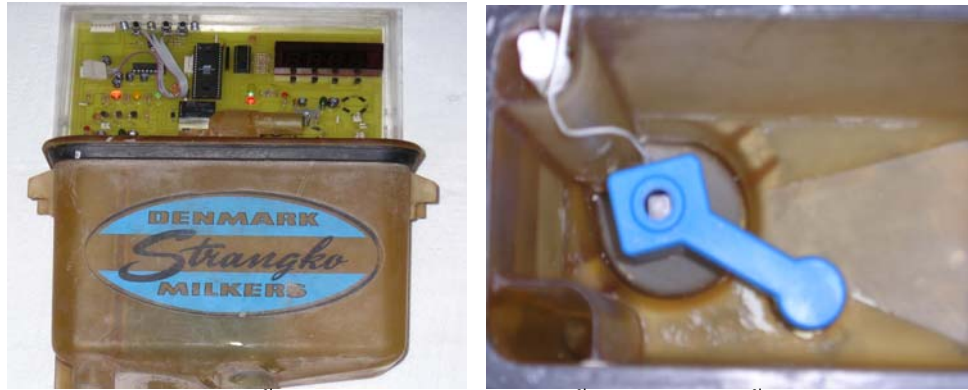
รูป 4.6 แสดงการติดตั้งระบบควบคุมใหม่ที่สร้างขึ้นกับเครื่องชั่งนํ้านมจากระบบเดิมและการติดตั้ง Sensor
