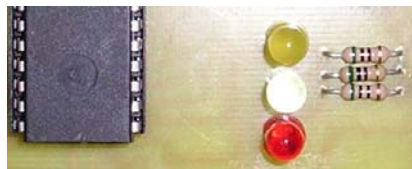
รูป 3.3 แสดงส่วนของ LED แทนการทำงานของสวิตช์ Start, Stop และ Sensor
