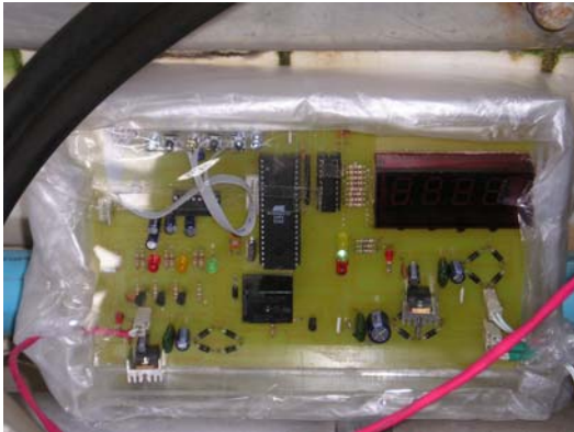
รูป 4.14 ข) แสดงเครื่องควบคุมการชั่งน้ำนมที่เราสร้างขึ้นโดยทำการติดตั้งกับเครื่องชั่งน้ำนมของระบบเดิมเพื่อทดสอบความสามารถในการทำงานร่วมกัน
