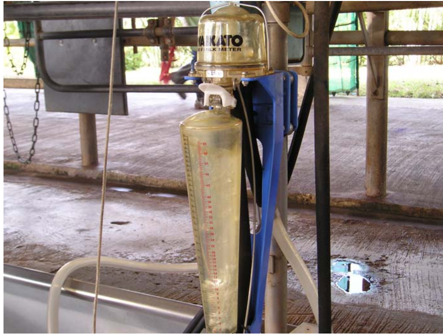
รูป 4.17 แสดงเครื่องชั่งระบบใหม่ที่ทางฟาร์มจัดซื้อมาเพื่อทดแทนระบบเดิม โดยเป็นระบบ Mechanic แทนที่ระบบเดิมที่เป็น Electronic
