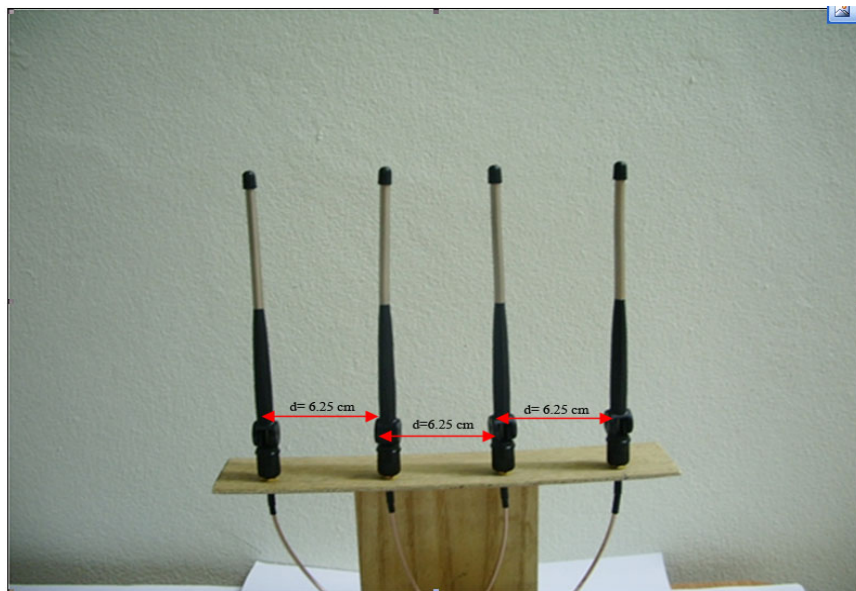
รูปที่ 3.37 แสดงระยะห่างของสายอากาศโมนิโพลจำนวน 4 ต้นที่สร้างขึ้นจริง
