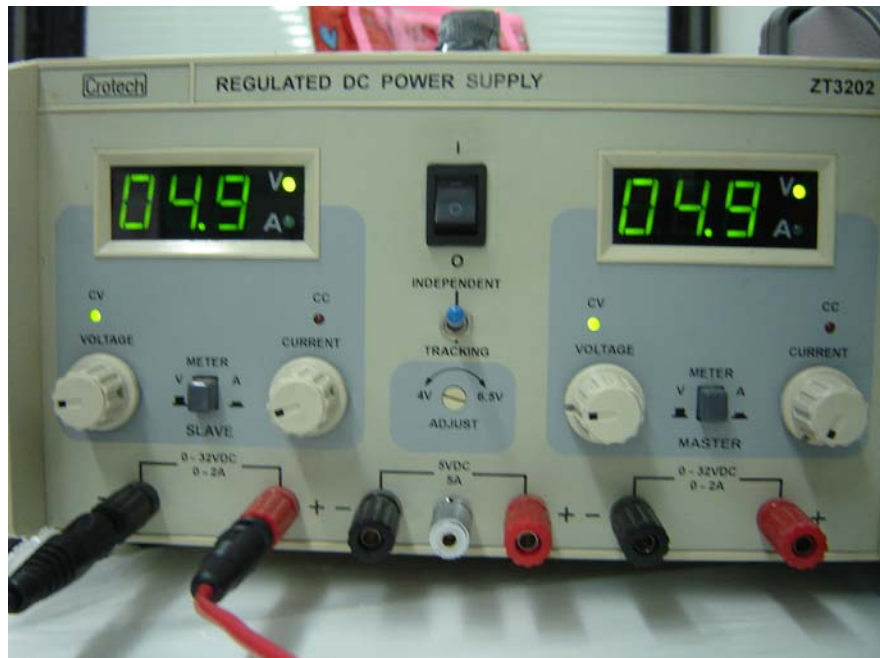
รูปที่ 4.29 แสดงภาพการจ่ายไฟประมาณ 5 โวลต์ให้กับวงจร
