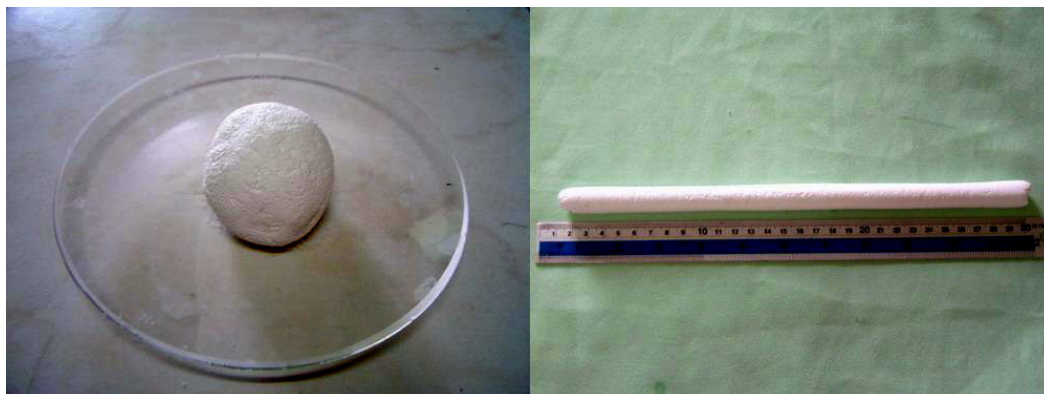
รูปที่ 4.8 แสดงลักษณะทางกายภาพของเนื้อส่วนผสมที่ใช้อนุภาคอะลูมินาขนาด 0.7 ไมครอน โดยใช้สารเติมแต่งชนิดคาร์บอกซีเมทิลเซลลูโลสร้อยละ 3 โดยน้ำหนักอะลูมินา
