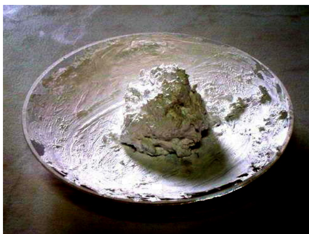
รูปที่ 4.9 แสดงลักษณะทางกายภาพของเนื้อส่วนผสมที่ใช้อนุภาคอะลูมินาขนาด 0.7 ไมครอน โดยใช้สารเติมแต่งชนิดโพลีไวนิลแอลกอฮอล์ร้อยละ 3 โดยน้ำหนักอะลูมินา
