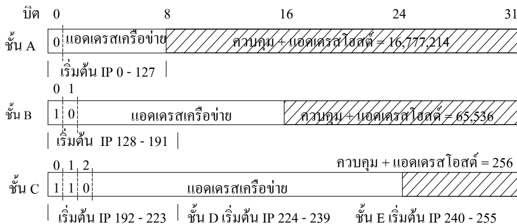
รูปที่ 2.23 การแบ่งชั้นของเครือข่ายหมายเลขแอดเดรส IP
