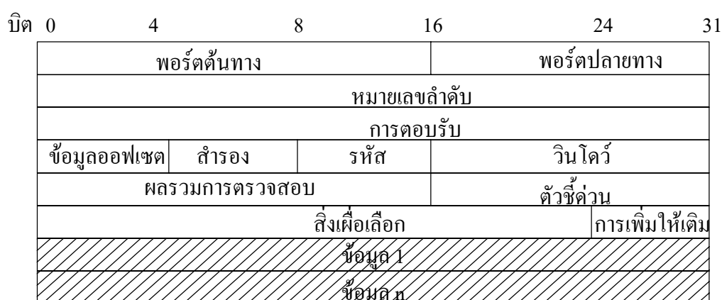
รูปที่ 2.21 เฟรมข้อมูลของโพรโตคอล TCP
