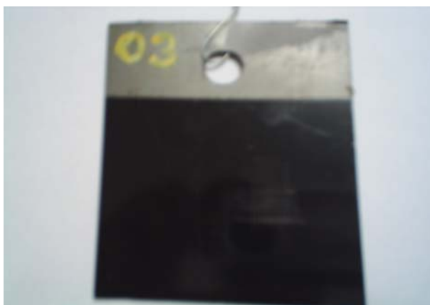
รูปที่ 4.8 ตัวอย่างของชิ้นงานที่ผ่านการเคลือบสังกะสีฟอสเฟตแล้วเคลือบสี
