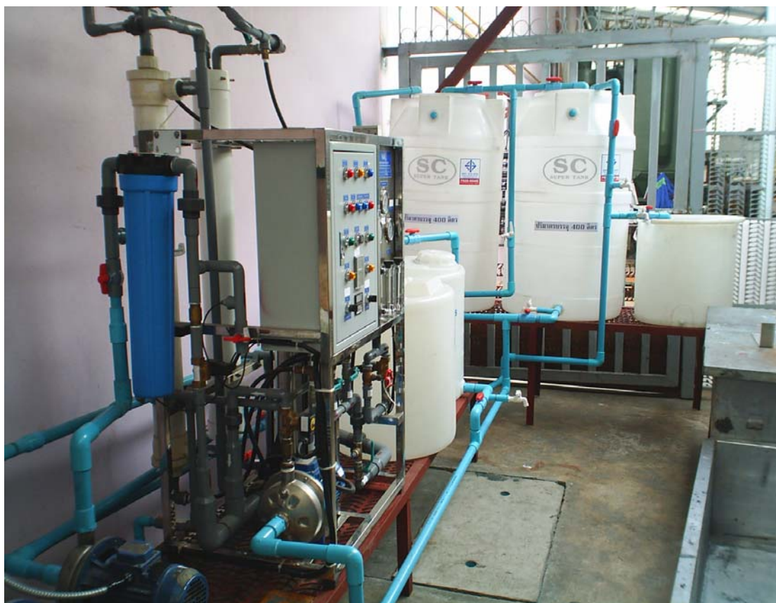
รูปที่ 3.11 อุปกรณ์ทดลองการปรับปรุงคุณภาพน้ำทิ้งเพื่อการนำกลับมาใช้ใหม่
