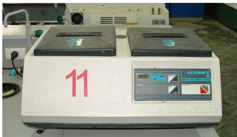
รูปที่ 3.4 เครื่องขัดชิ้นงานแบบจานหมุน
