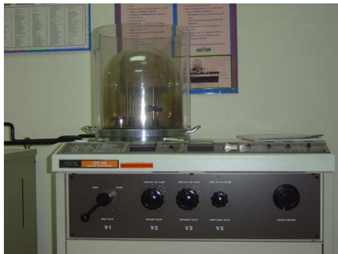
รูปที่ 3.5 เครื่องทำระเหยในสุญญากาศ (Vacuum Evaporator)
