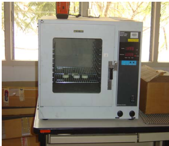
รูปที่ 3.8 ตู้ควบคุมอุณหภูมิ
