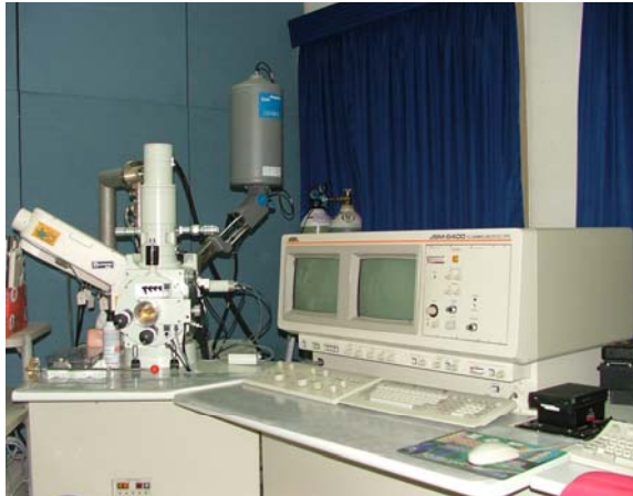
รูปที่ 3.6 กล้องจุลทรรศน์อิเล็กตรอนแบบส่องกราด (Scanning electron microscope, SEM)
