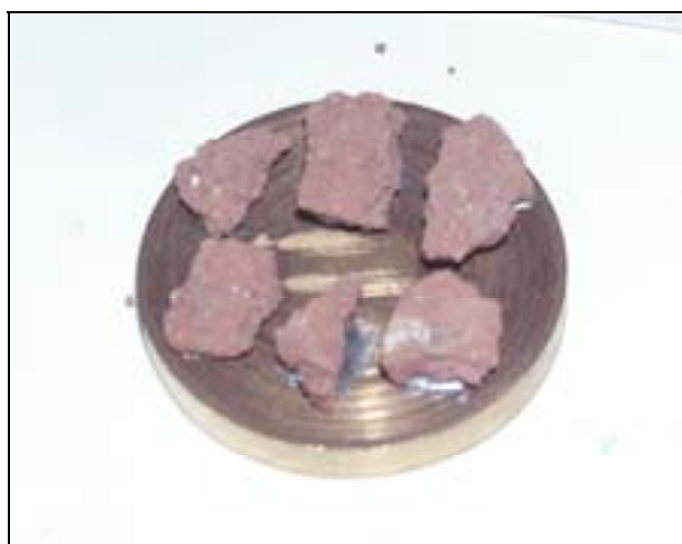
รูปที่ 3.11 ดินตัวอย่างที่ถูกย่อยและติดบนแท่งติดตัวอย่าง
