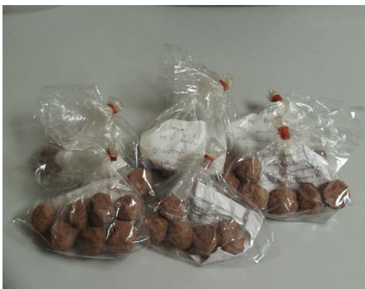
รูปที่ 3.5 ตัวอย่างดินหลังจากแต่งให้มีขนาด 1 เซนติเมตร
