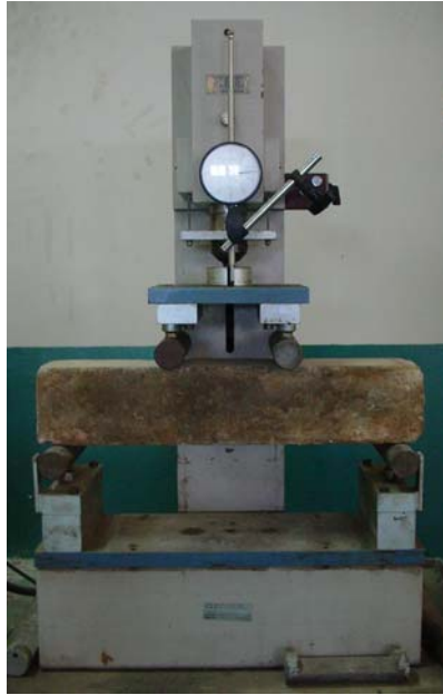
รูปที่ 3.5 การติดตั้งตัวอย่างทดสอบที่ใช้ทดสอบกำลังรับแรงอัด
