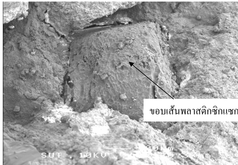
รูปที่ 4.39 ลักษณะเส้นพลาสติกซิกแซกในเนื้อคอนกรีต
