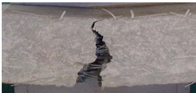
รูปที่ 17 แสดงลักษณะการวิบัติของคานคอนกรีตที่เสริมเส้นพลาสติก
