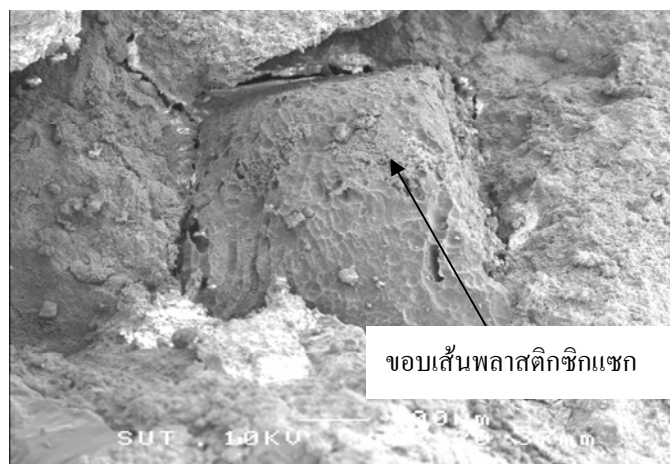
รูปที่ 9 เส้นพลาสติกขอบซิกแซกในเนื้อคอนกรีต
