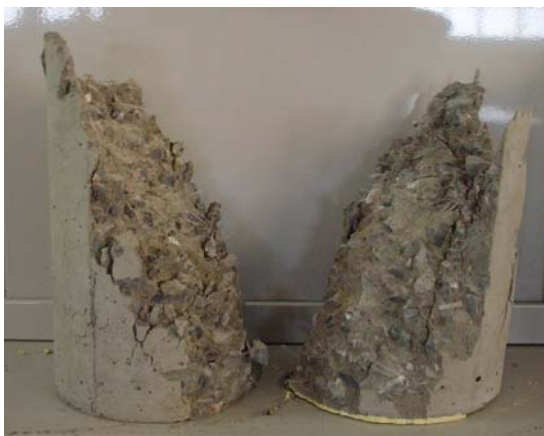
รูปที่ 4.49 ลักษณะการวิบัติของตัวอย่างทดสอบคอนกรีตรูปทรงกระบอก
