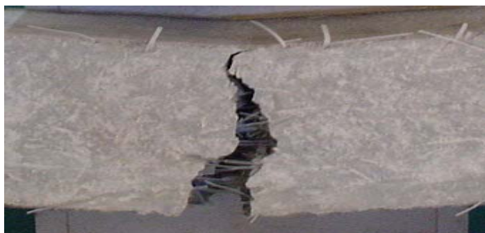
รูปที่ 4.50 ลักษณะการวิบัติของคานคอนกรีตที่เสริมเส้นพลาสติก
