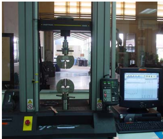
รูปที่ 3.3 การติดตั้งตัวอย่างทดสอบที่ใช้ทดสอบกำลังรับแรงดึงของเส้นพลาสติก
