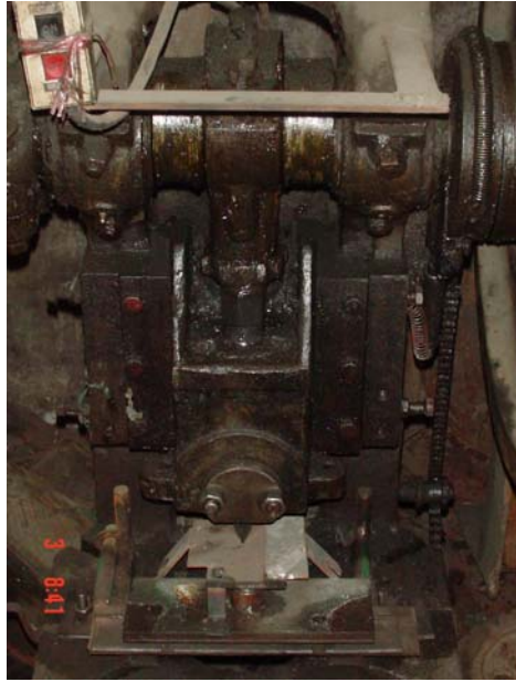
รูปที่ ข.3 เครื่องตัดเส้นพลาสติกชักแซก
