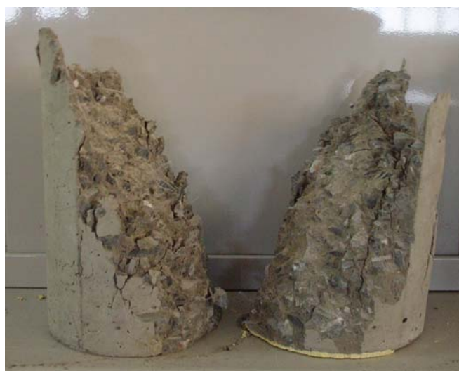
รูปที่ 16 แสดงลักษณะการวิบัติของตัวอย่างทดสอบคอนกรีตรูปทรงกระบอก
