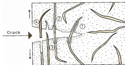
รูปที่ 2.2 ลักษณะของเส้นใยในคอนกรีตหรือมอร์ต้า (Swamy, 1988)
