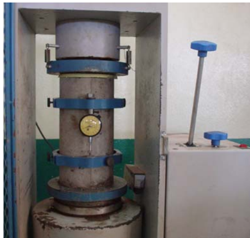
รูปที่ 3.4 การติดตั้งตัวอย่างทดสอบที่ใช้ทดสอบกำลังรับแรงอัด
