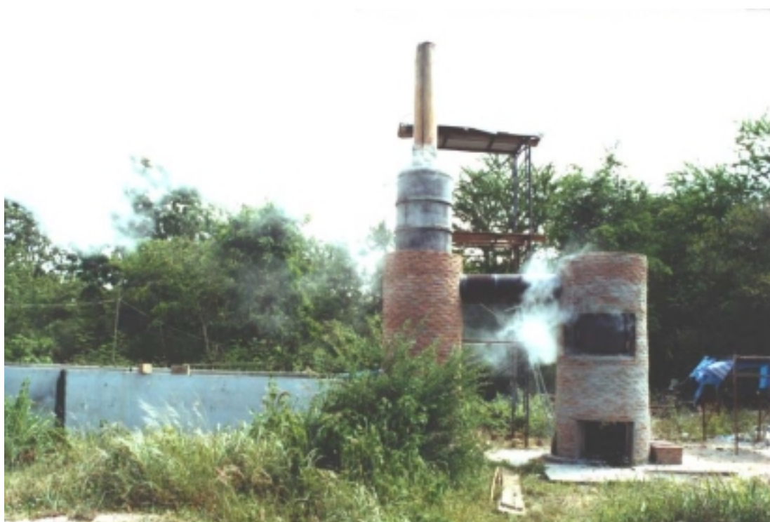
ภาพที่ 3.2 ส่วนประกอบของเตาเผาขยะมูลฝอยชุมชนขนาดเล็ก
