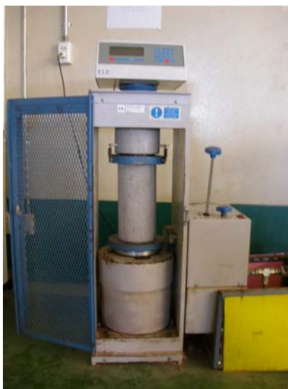
รูปที่ 3.3 เครื่องทดสอบแรงกดอัดของคอนกรีต
