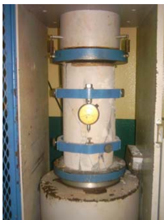
รูปที่ 3.4 การติดตั้งตัวอย่างคอนกรีตเข้ากับเครื่องทดสอบ
