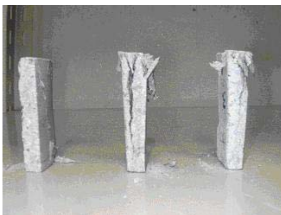
รูปที่ ค4 ตัวอย่างลักษณะการวิบัติของตัวอย่างวัสดุซีเมนต์ไยหินภายใต้แรงกดอัด
