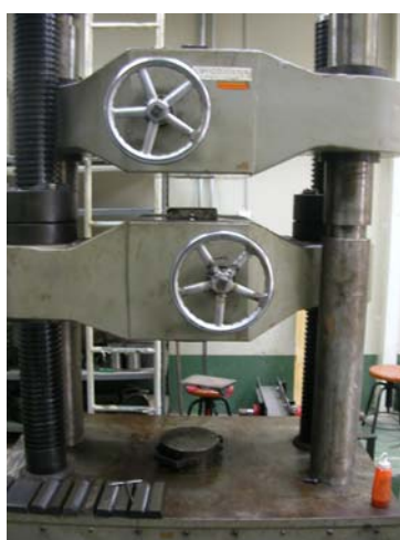
รูปที่ 3.7 เครื่องทดสอบ Universal Testing Machine (SHIMADZU รุ่น UH-Series) และการทดสอบตัวอย่างวัสดุซีเมนต์ไยหิน
