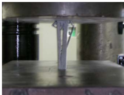
รูปที่ 3.7 เครื่องทดสอบ Universal Testing Machine (SHIMADZU รุ่น UH-Series) และการทดสอบตัวอย่างวัสดุซีเมนต์ไยหิน
