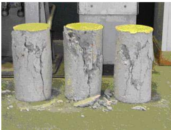
รูปที่ ค2 ลักษณะการวิบัติของตัวอย่างคอนกรีตภายใต้แรงกดอัด
