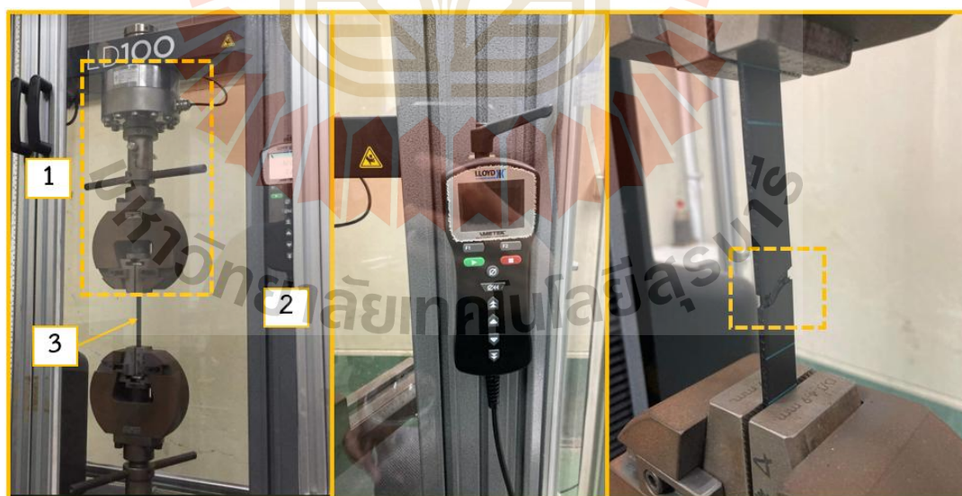
รูปที่ 3.8 ภาพแสดงเครื่องทดสอบแรงอเนกประสงค์ Lloyd รุ่น LD 100 (ซ้าย) หน้าจอบอกระยะของปากกาจับชิ้นงานของเครื่องทดสอบ (กลาง) และการแตกหักของชิ้นงานทดสอบ (ขวา)
