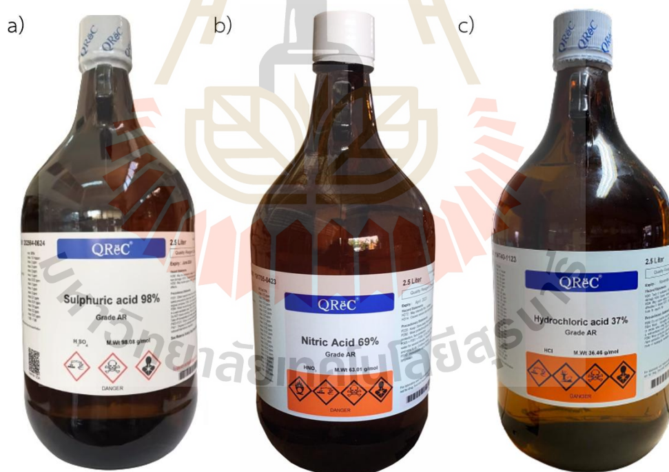
รูปที่ 3.2 ตัวอย่างสารเคมีที่ใช้ในกระบวนการชะละลาย a) กรดซัลฟิวริก b) กรดไนตริก และ c) กรดไฮโดรคลอริก
