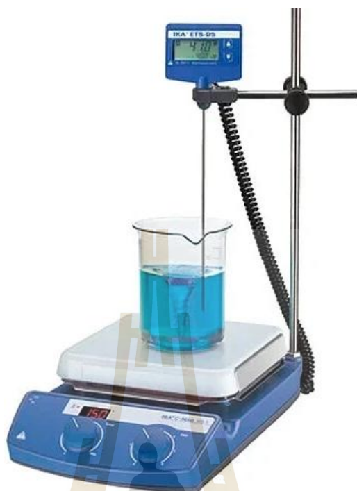
รูปที่ 3.5 เครื่องกวนสารละลายด้วยแท่งแม่เหล็กที่มีตัวให้ความร้อน
