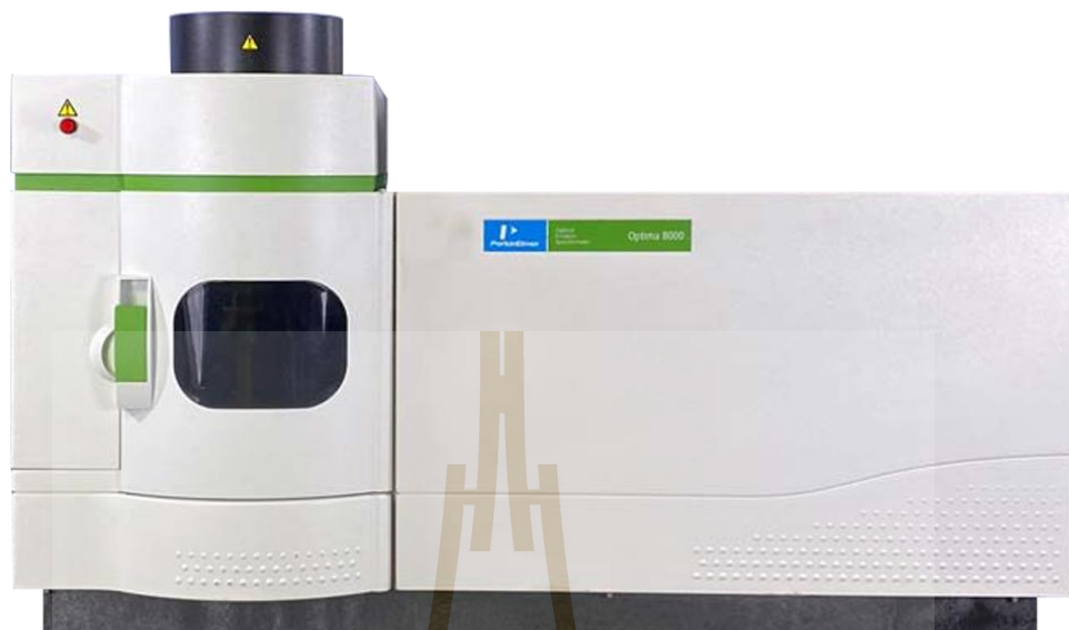
รูปที่ 3.12 เครื่องวิเคราะห์ปริมาณธาตุโดยอาศัยหลักการคายแสงของธาตุจากการกระตุ้นด้วยพลาสมา
