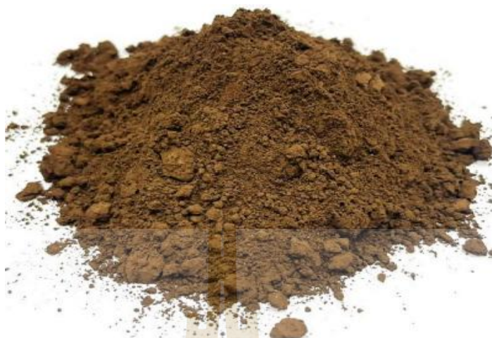
รูปที่ 2.3 ตัวอย่างลักษณะทางกายภาพของฝุ่นเตาอาร์กไฟฟ้า
