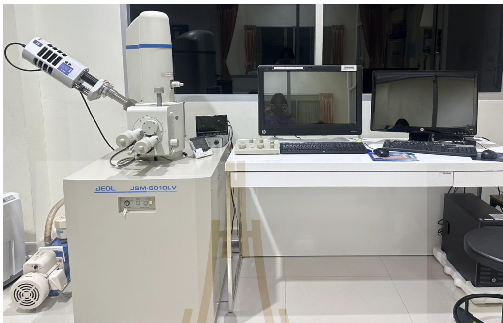
รูปที่ 3.10 กล้องจุลทรรศน์อิเล็กตรอนแบบส่องกราดและการวิเคราะห์ธาตุด้วยเทคนิคการวัดการกระจายพลังงานของรังสีเอกซ์
