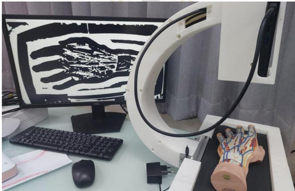
รูปที่ 4.4 การตรวจสอบ FOV ของเครื่องต้นแบบ Vein Finder
