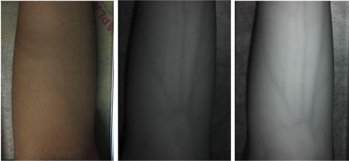
รูปที่ 4.6 ผลลัพธ์การแสดงผลภาพจากกล้องสามแบบ — กล้องธรรมดา (ซ้าย), กล้อง Basler (กลาง), และภาพภายใต้แสงอินฟราเรด (ขวา)
