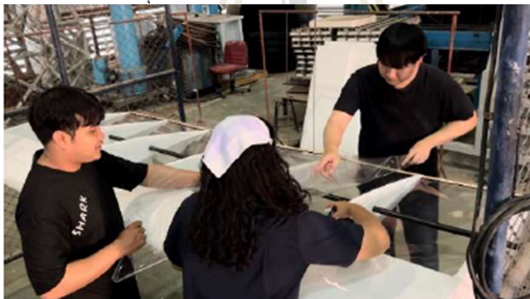
รูปที่ 4.20 ประกอบ Mylar Film เข้ากับ Rib
