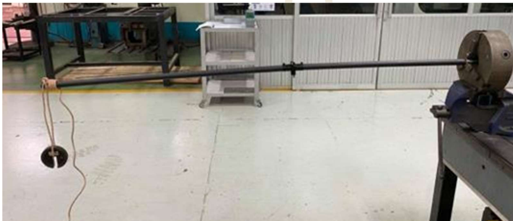
รูปที่ 3.5 การทดลองหาระยะยืดของท่อยาว 1 เมตรที่มี ข้อต่อ
