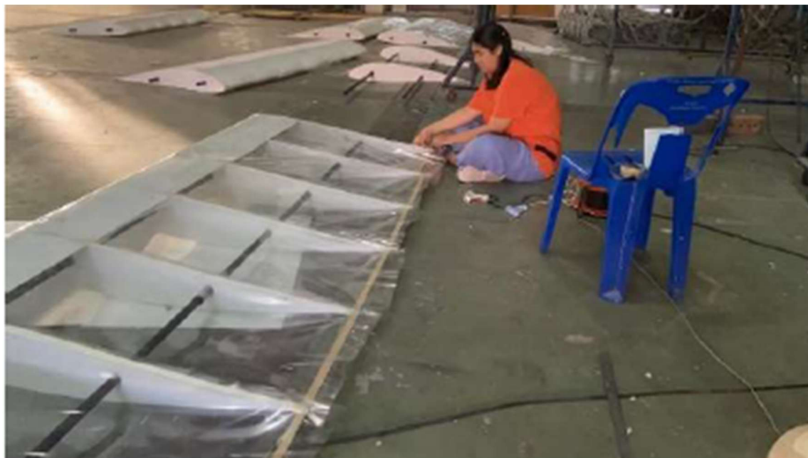
รูปที่ 4.21 ดึงMylar Film ให้ติดกับ Tailing edge
