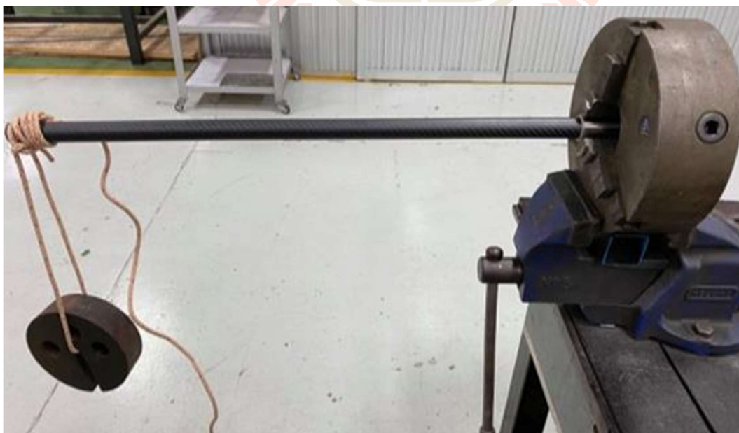
รูปที่ 3.3 การทดลองหาระยะยึดของท่อยาว 1 เมตร
