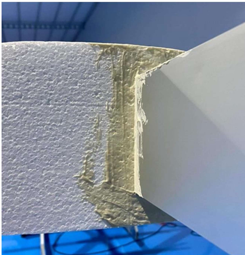
รูปที่ 5.15 กาว PVC เสริมความแข็งแรงของ Rib บริเวณเชื่อมกับ Spar
