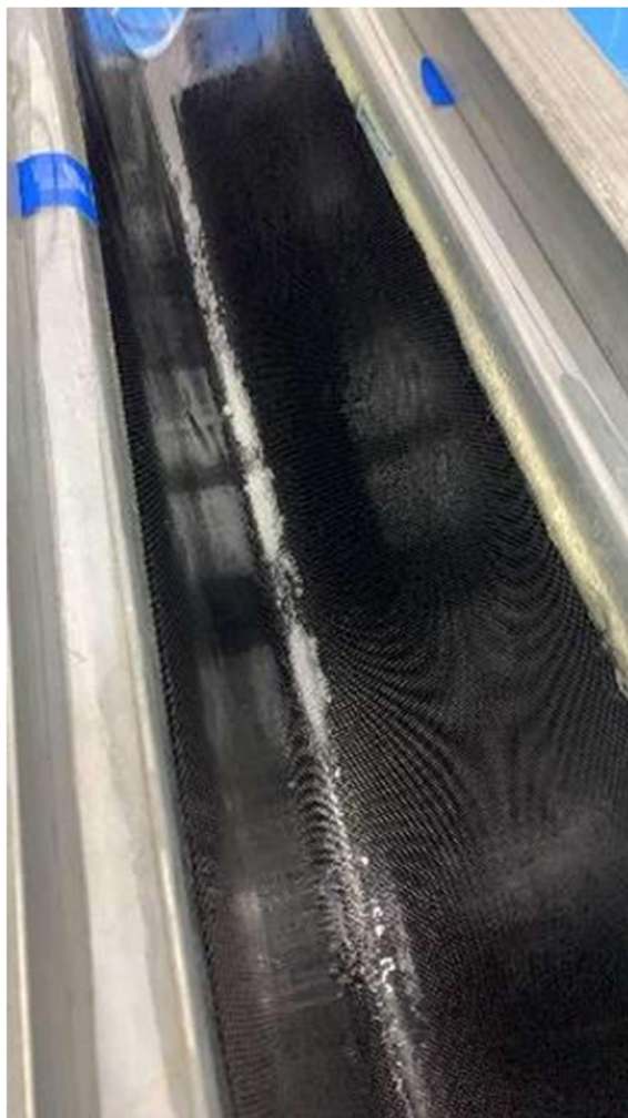
รูปที่ 5.20 การ Lay up คาร์บอนไฟเบอร์ และการอบ
