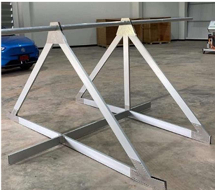
รูปที่ 5.9 โครงสร้าง Fuselage ผลิตด้วย Aluminum
