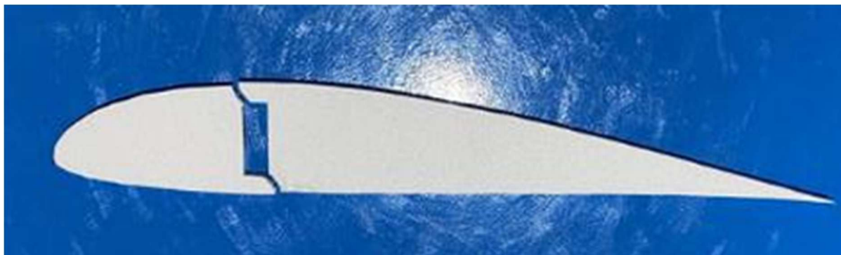
รูปที่ 5.14 การแตกหักของ Rib โฟม
