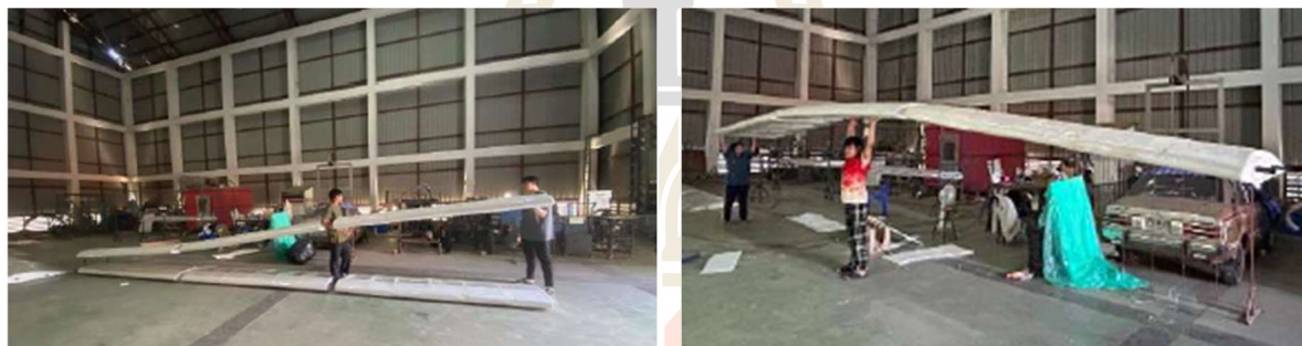
รูปที่ 4.22 ประกอบปีกเข้าด้วยกัน 9 เมตร
