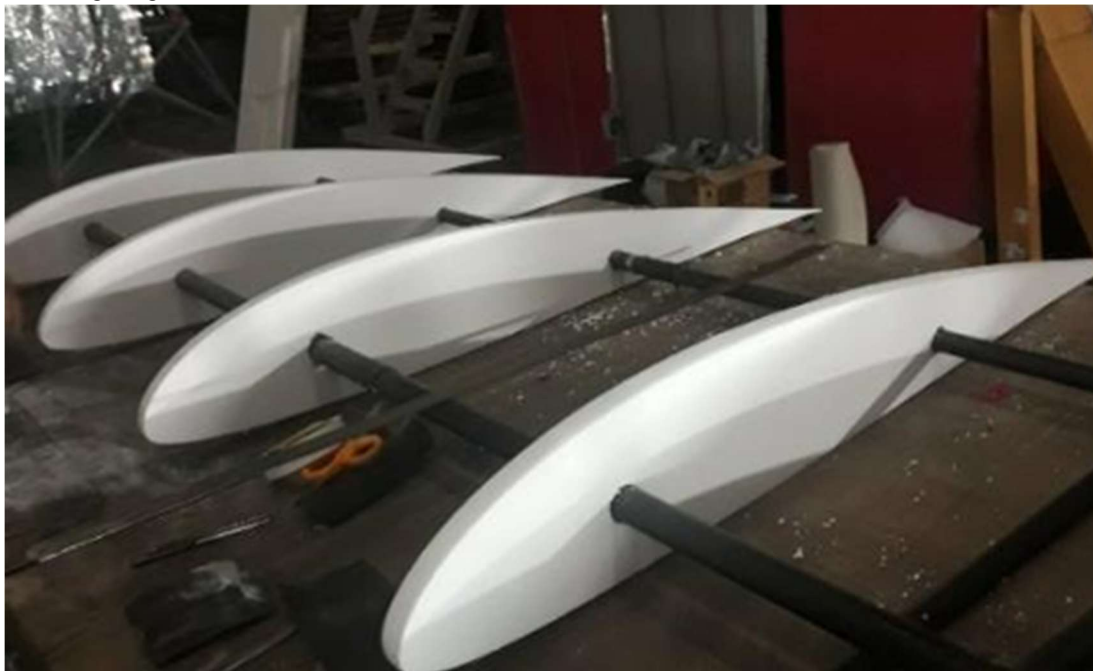
รูปที่ 4.4 โครงสร้างปีกกล่องที่ประกอบ Spar และ rib
