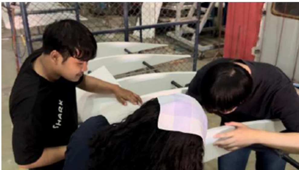
รูปที่ 4.19 ประกอบ Leading Edge เข้ากับท่อน Spar
