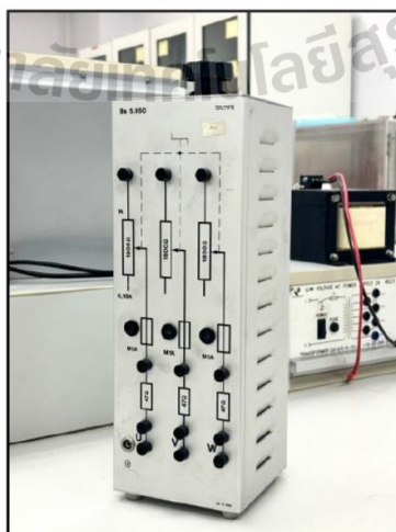
รูปที่ 7.20 โหลดความต้านทานของชุดทดสอบระบบไฟฟ้ากำลังบนเครื่องบิน
