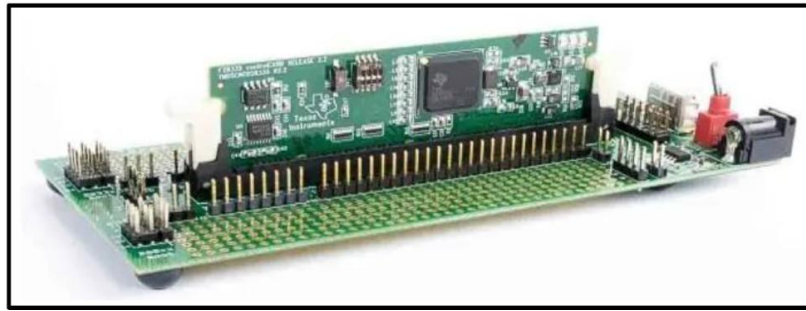
รูปที่ 7.12 ชุดบอร์ด DSP รุ่น TMS320F28335 Experimenter Kit
