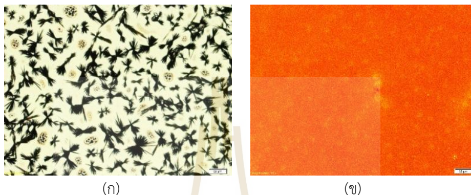
รูปที่ 5.8 ภาพถ่ายฟิล์มบาง PS บนชั้นฟิล์มบาง AZO(2L)/ZnO:Bi(2L)/ITO/Glass ที่กำลังขยาย 100 เท่า (ก) ไม่ใส่สารปรับปรุงพื้นผิว และ(ข) ใส่สารปรับปรุงพื้นผิว EA: IPA ที่อัตราส่วน 1:2
