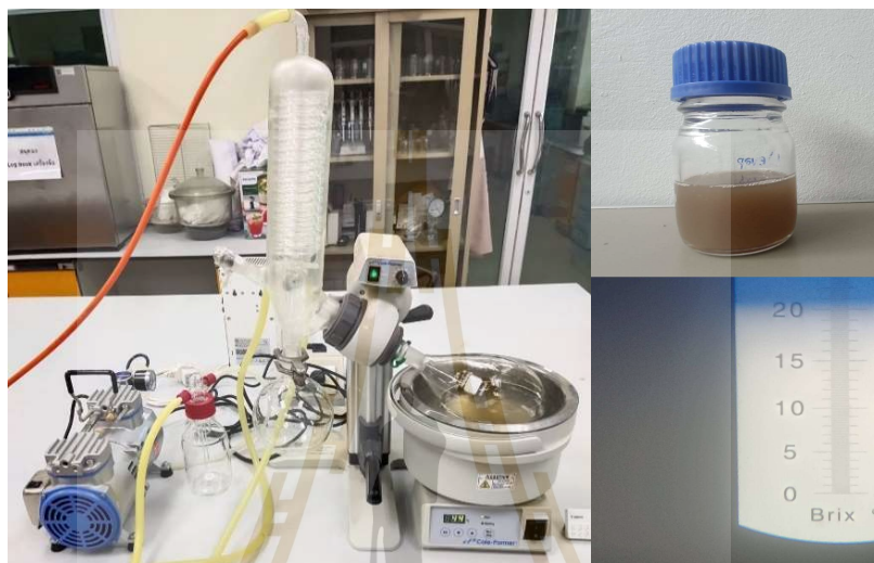
รูปที่ 3.10 ภาพการดำเนินการทำให้สารสกัดเข้มข้นเครื่องกลั่นระเหยสารแบบหมุน
