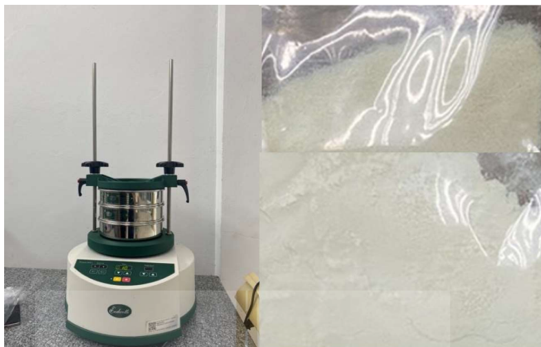
รูปที่ 3.4 ภาพการดำเนินการร่อนแยกขนาดด้วยเครื่องร่อนและตะแกรงร่อน
