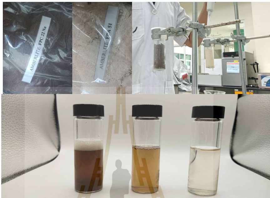
รูปที่ 3.9 ภาพการดำเนินการทำบริสุทธิ์สารด้วย Ion exchange resin
