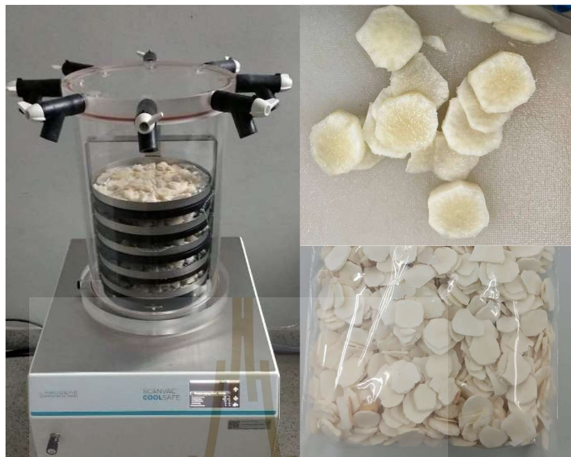
รูปที่ 3.2 ภาพการดำเนินการทำแห้งห้วแกนตะวันด้วยเครื่องทำแห้งแบบแช่เยือกแข็ง
