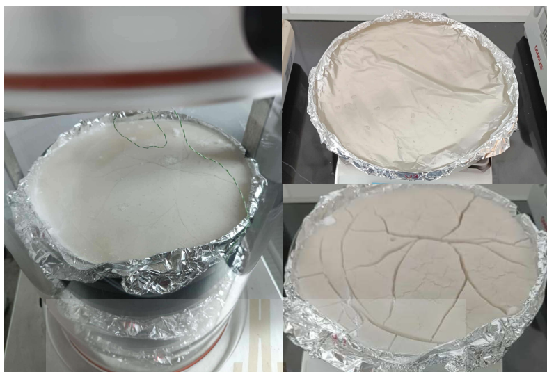
รูปที่ 3.12 การทำแห้งแบบแช่เยือกแข็งสารสกัดอินนูลิน
