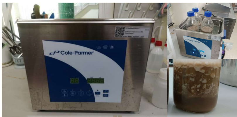
รูปที่ 3.7 ภาพการดำเนินการสกัดสารอินูลินด้วยเครื่องคลื่นเสียงความถี่สูง
