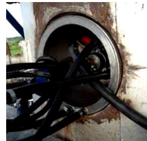
พลาสมาอาร์คเพื่อเป็นความร้อน เสริมในเตาปฏิกรณ์
