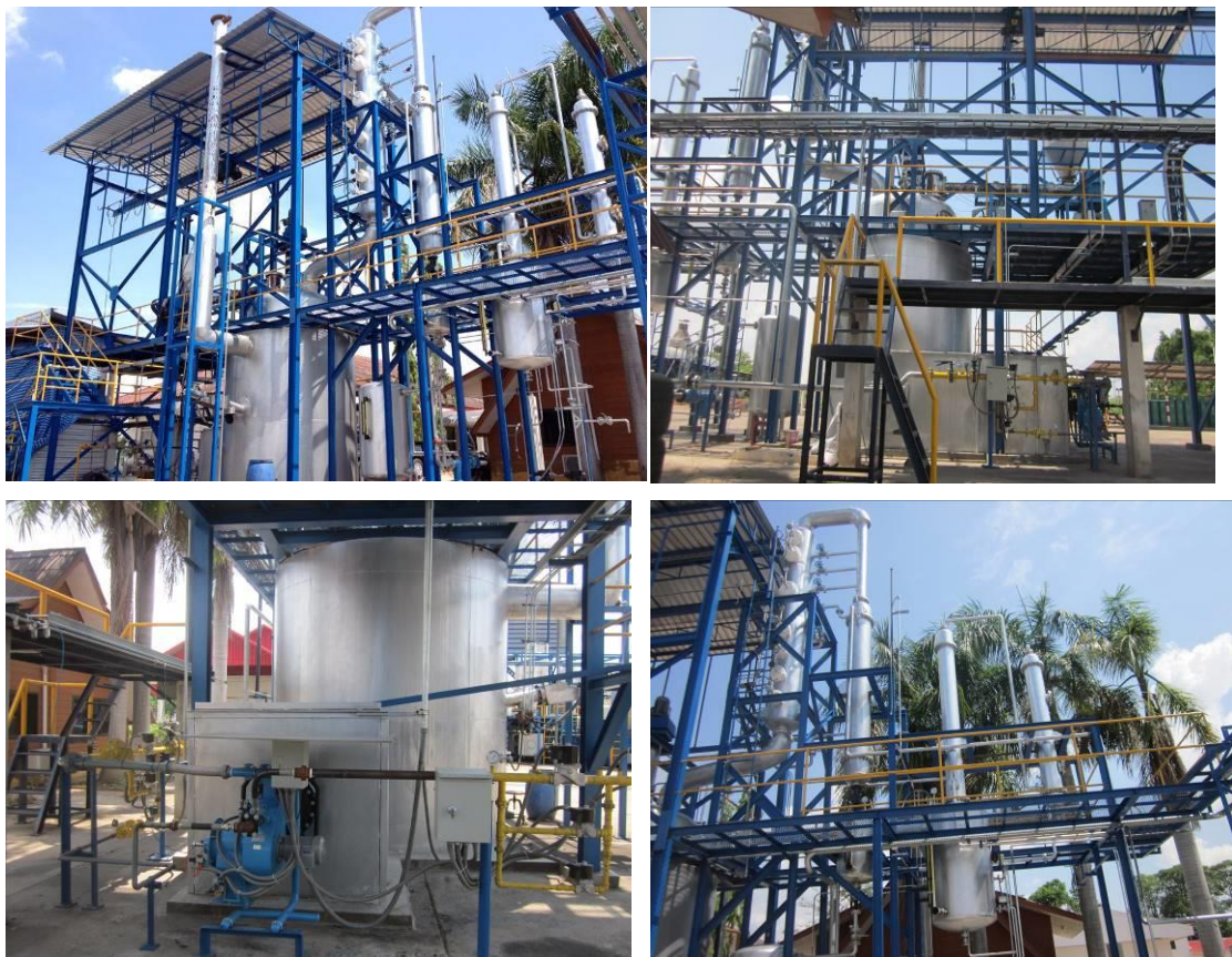
รูปที่ 2 ต้นแบบโรงงานแปรรูปขยะเป็นน้ำมันของ มหาวิทยาลัยเทคโนโลยีสุรนารี (โดยใช้เชื้อเพลิงขยะพลาสติกจากระบบ MBT และโรงงานผลิตเชื้อเพลิงขยะ RDF-4) ของมหาวิทยาลัยฯ)
