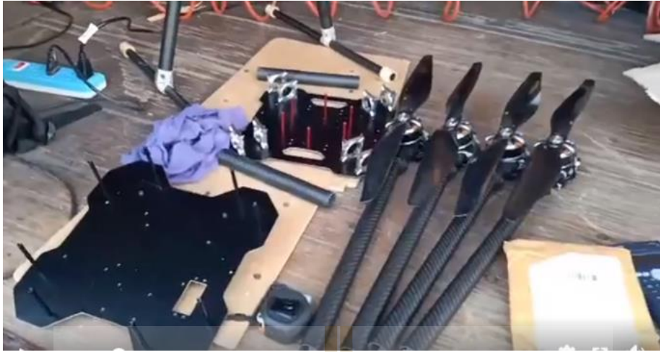
รูปที่ 18 ชิ้นส่วนที่กัด CNC เสร็จและแชนของโดรนที่ประกอบใบพัดเรียบร้อยแล้ว
