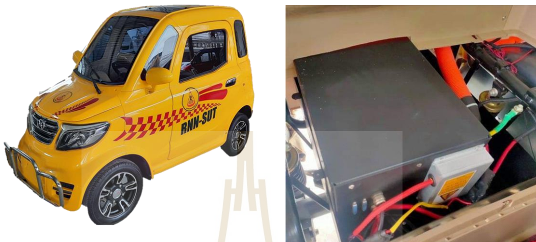
รูปที่ 4.2 ยานยนต์ไฟฟ้าและแบตเตอรี่ที่ติดตั้ง on-board ในยานยนต์ไฟฟ้า
