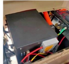
รูปที่ 6 แบตเตอรี่ที่ติดตั้งภายในยานยนต์ไฟฟ้า
