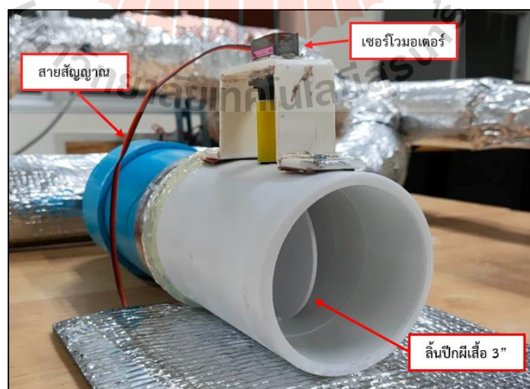
รูปที่ 3.25 วาล์วควบคุมการไหลชนิดปีกผีเสื้อขับเคลื่อนด้วยเซอร์โวมอเตอร์
