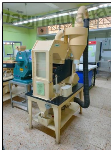
รูปที่ 3.5 เครื่องทำความสะอาดเมล็ดพันธุ์ด้วยตะแกรงและแรงลม
