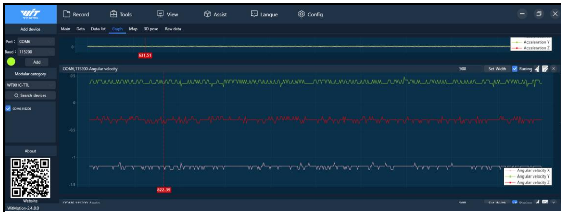
รูปที่ 3.10 ค่า \omega_z รอบแกน Yaw ที่ปิดใช้งานระบบสอบเทียบอัตโนมัติของไจโรสโคป (สีแดง)
