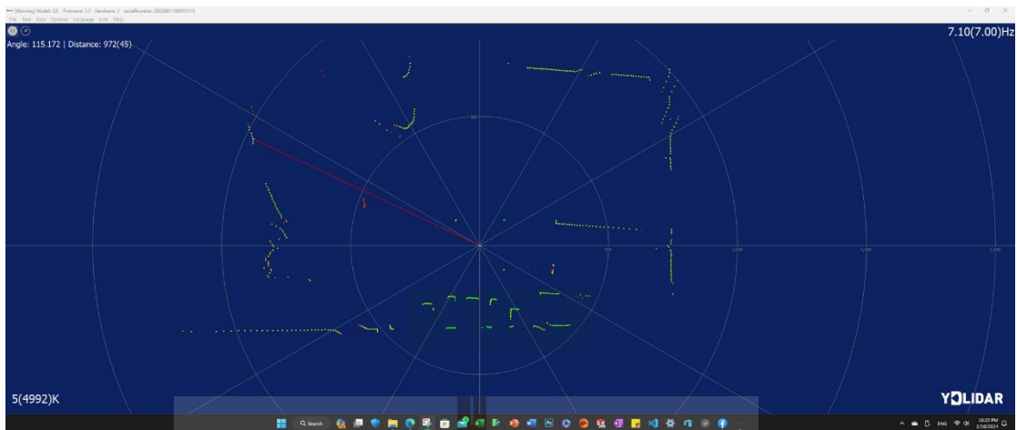
รูปที่ ก.9 การทดสอบเซนเซอร์ YDLIDAR G2 ด้วยโปรแกรม Lidar Viewer
