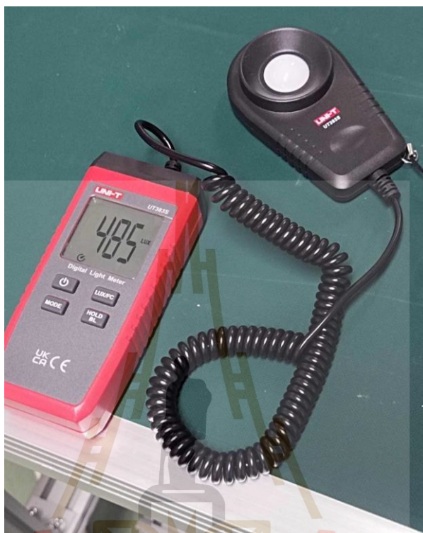
รูปที่ 3.14 ตัวอย่างการวัดความสว่างด้วยเครื่องวัด
