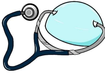
รูปที่ 2.3.1 แสดงรูปลักษณะของอุปกรณ์ที่ถูกออกแบบไว้ (สีฟ้า) เพื่อรับเสียงจากสเตโทสโคปที่มีอยู่แล้วในทุกโรงพยาบาลทั่วไป
