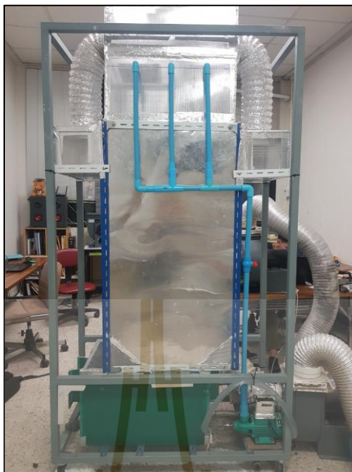
ฉ) เครื่องต้นแบบ STEC ที่ติดตั้งท่อน้ำ ท่ออากาศ และโบลเวอร์
