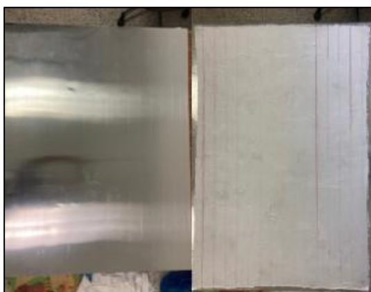
ค) การติดผ้าบนแผ่นอะลูมิเนียม ง) การขีดเส้นบนแผ่นอะลูมิเนียม
