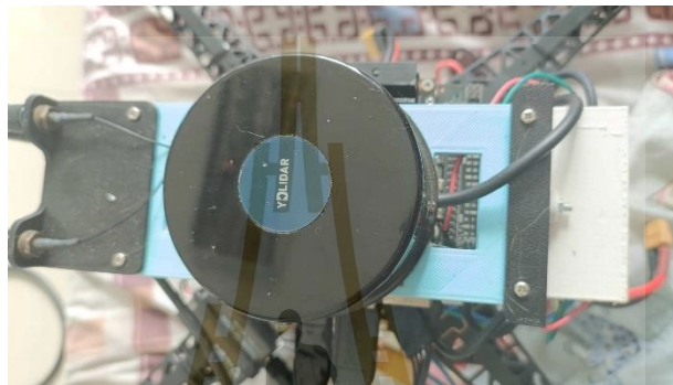
รูปที่ 2.19 LiDAR 360 องศา
