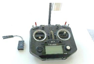
รูปที่ 2.10 อุปกรณ์ส่งและรับสัญญาณวิทยุบังคับ
