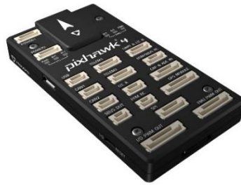
รูปที่ 2.6 บอร์ด Pixhawk4 (PX4Docs, 2021)
