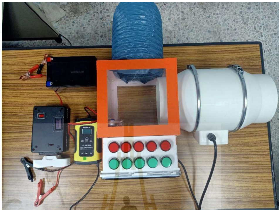
รูปที่ 3.7 ชุดระบายอากาศและตรวจสอบสภาพอากาศในที่อับอากาศแบบเคลื่อนที่
