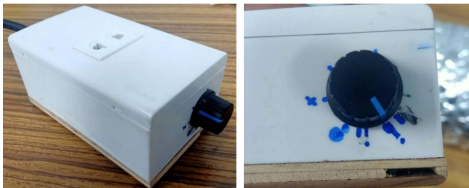
รูปที่ 3.10 โมดูลปรับแรงดันไฟฟ้า (Dimmer AC 220 V 2,000 W) และการทำสัญลักษณ์อัตราการไหลที่ทำการทดสอบ
