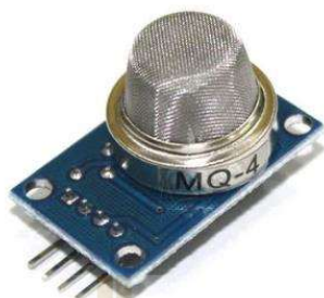
รูปที่ 2.8 เซนเซอร์ตรวจวัดปริมาณก๊าซมีเทน (MQ-4 Gas Sensor Module)
