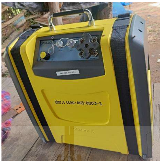
รูปที่ 3.23 เครื่องวิเคราะห์ก๊าซในอากาศ Gasmeter DX4040
