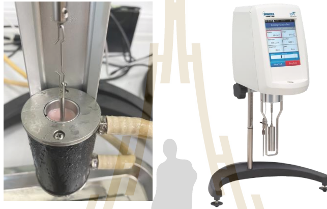
รูปที่ 3.5 เครื่องวัดความหนืด (Viscometer)
