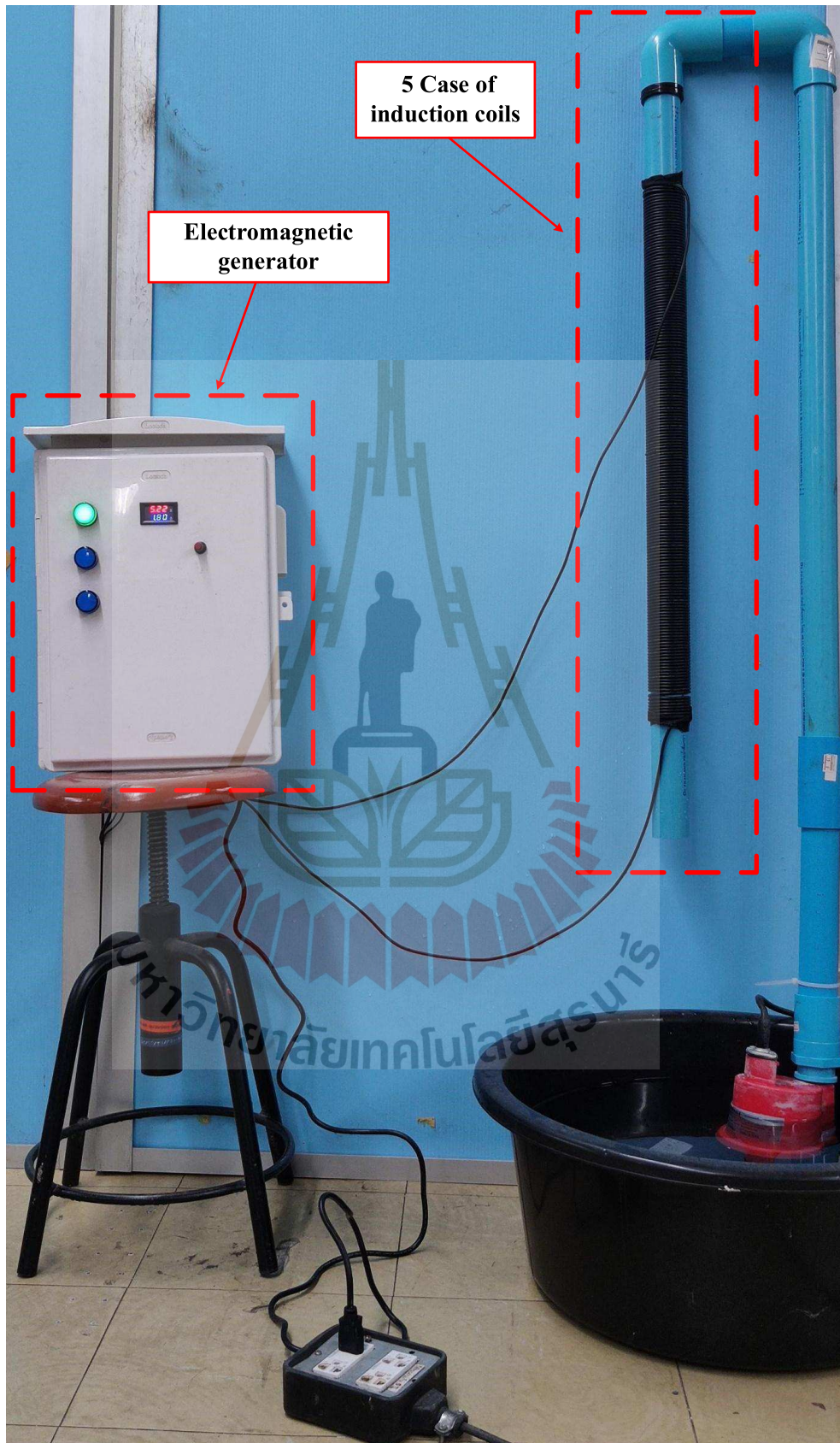
รูปที่ 3.26 ระบบการเวียนน้ำผ่านขดลวด
