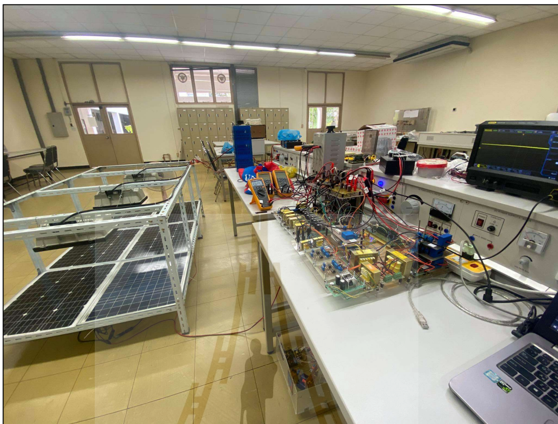
รูปที่ 7.14 ชุดต้นแบบวงจรอินเวอร์เตอร์แหล่งจ่ายอิมพีแดนซ์แบบควอไซต์โหมตอิสระ ในห้องปฏิบัติการ
