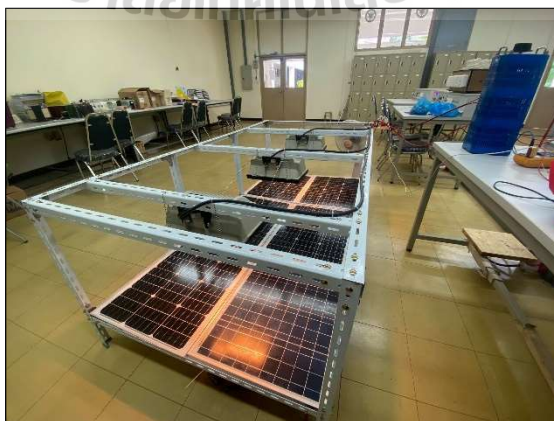
รูปที่ 7.16 แผงเซลล์แสงอาทิตย์ที่ใช้ในชุดทดสอบจริง
