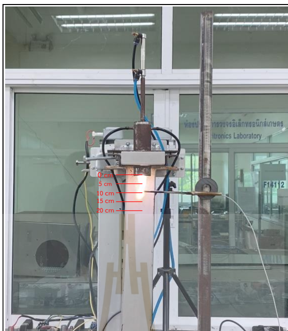
รูปที่ 5.13 การทดสอบแหล่งกำเนิดพลาสติกความร้อนเมื่อใช้ท่อนำคลื่นแบบรวมกำลังงาน
