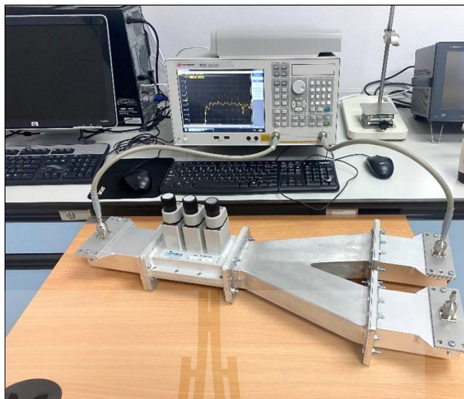
รูปที่ 5.4 การทดสอบวัดค่าพารามิเตอร์ที่นำคลื่นแบบรวมกำลังงานเมื่อเพิ่มสตับจูนเนอร์โดยใช้เครื่องวิเคราะห์โคร่งข่ายแบบสองทาง
