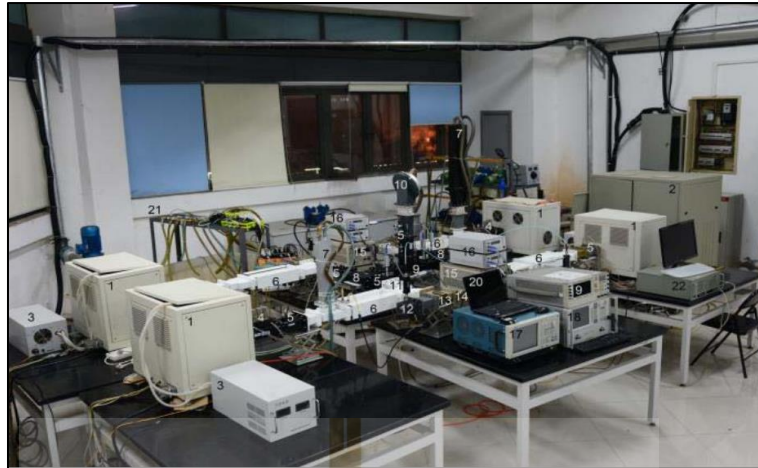
รูปที่ 2.12 การตั้งค่าระบบรวมกำลังงานสำหรับแมกนีตรอนแบบต่อเนื่องขนาด 60 กิโลวัตต์
