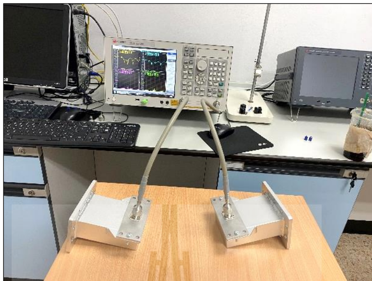
รูปที่ 5.2 การทดสอบวัดค่าพารามิเตอร์ที่หน้าคลื่นขนาด WR340 โดยใช้เครื่องวิเคราะห์โครงข่ายแบบสองทาง
