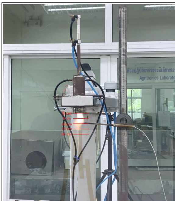
รูปที่ 5.14 การทดสอบแหล่งกำเนิดพลาสมาความร้อนเมื่อใช้ท่อนำคลื่นแบบรวมกำลังงานร่วมกับ สตัมป์จูนเนอร์
