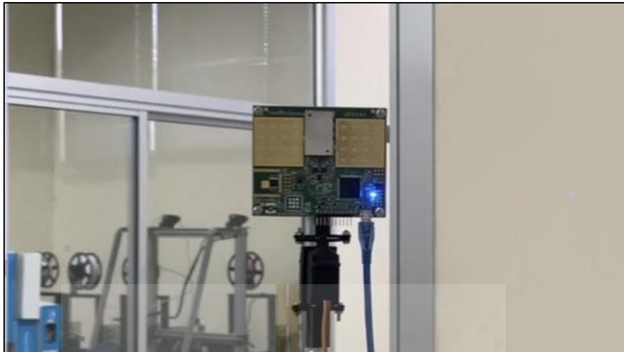
รูปที่ 4.4 ภาพแสดงสัญญาณไฟสีฟ้าเมื่อวัตถุมีการเคลื่อนที่ออกจากเรดาร์
