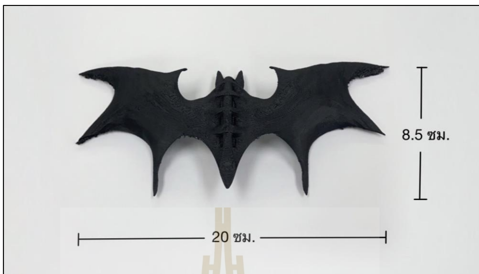
รูปที่ 3.19 ขนาดของแบบจำลองค้างคาว
