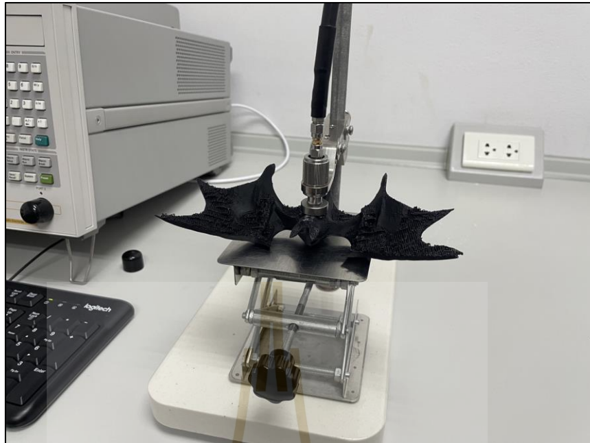
รูปที่ 3.24 การวัดค่าไดอิเล็กทริกของค้ำควาจำลอง
