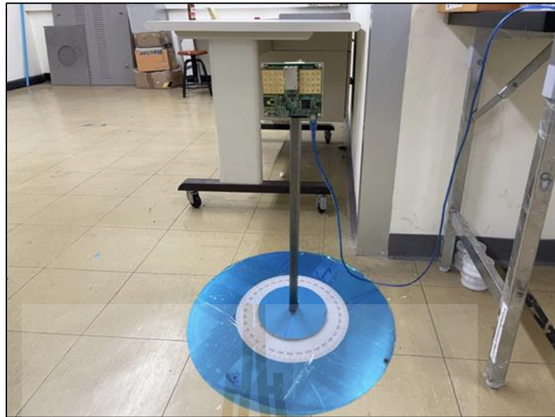
รูปที่ 3.5 ชุดจางานหมุน 360 องศาวัตแบบแผนรูปแบบการกระจายของคลื่น
