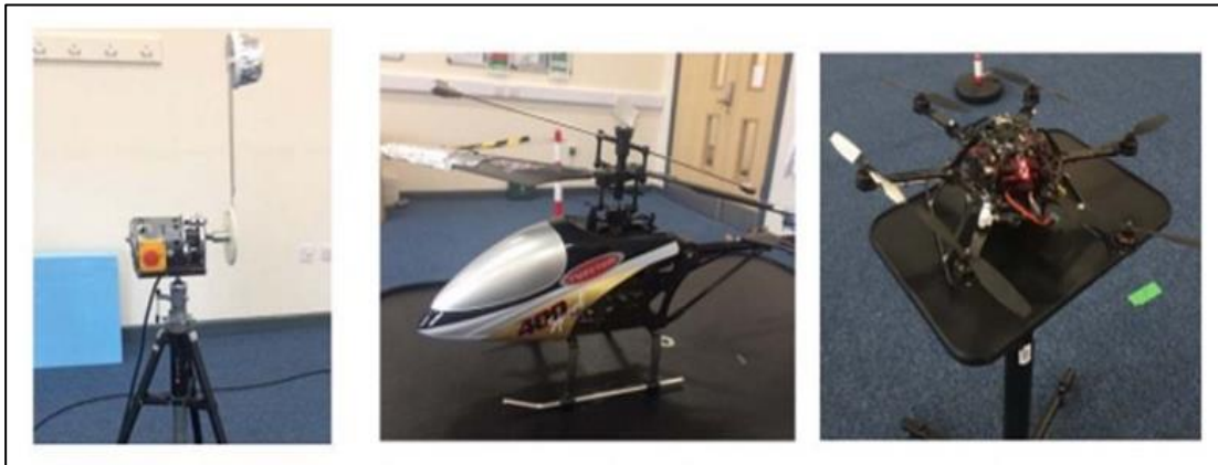
รูปที่ 1.7 โดรนนาโนที่ใช้ในการทดสอบเรดาร์ FMCW
